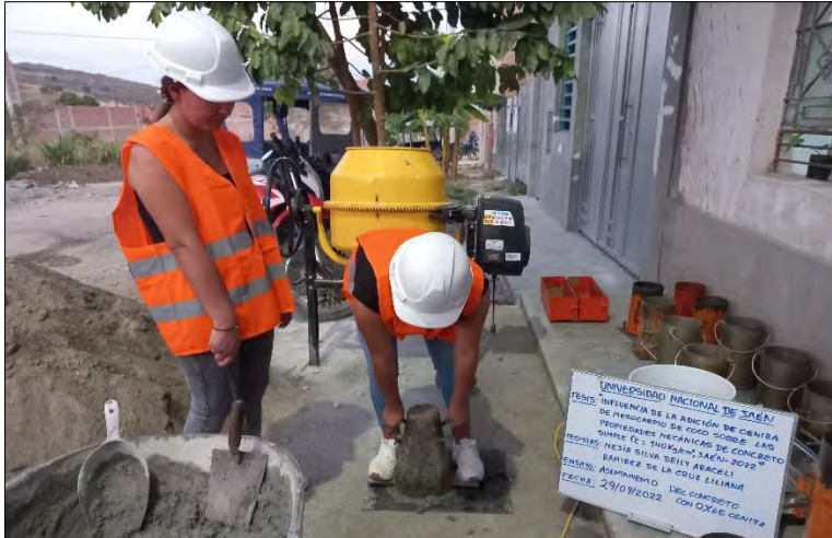
Ensayo de asentamiento (Slump) con 0% de adición
