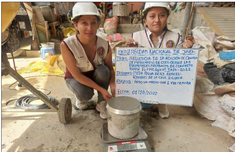
Ensayo de peso unitario con 1% de adición
