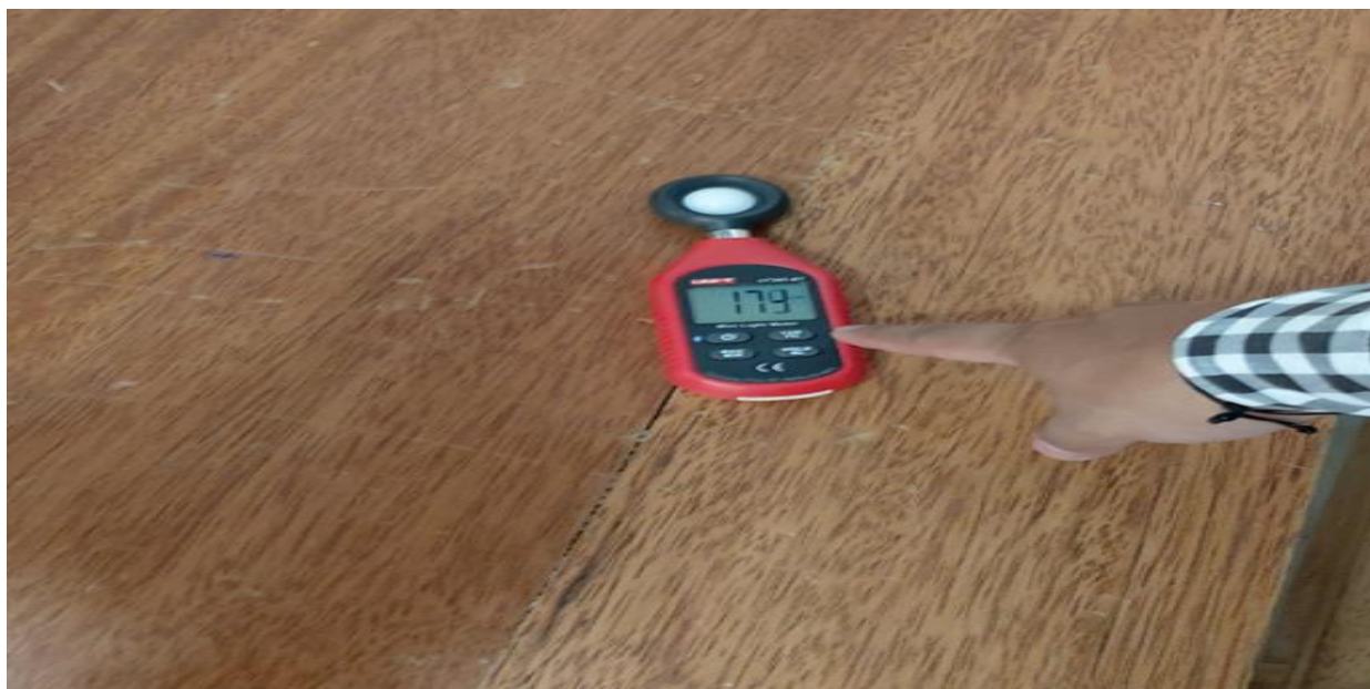
Figura N°56: Resultado del diagnóstico Lúmenes /m 2 de las aulas de clase con el Luxómetro.
