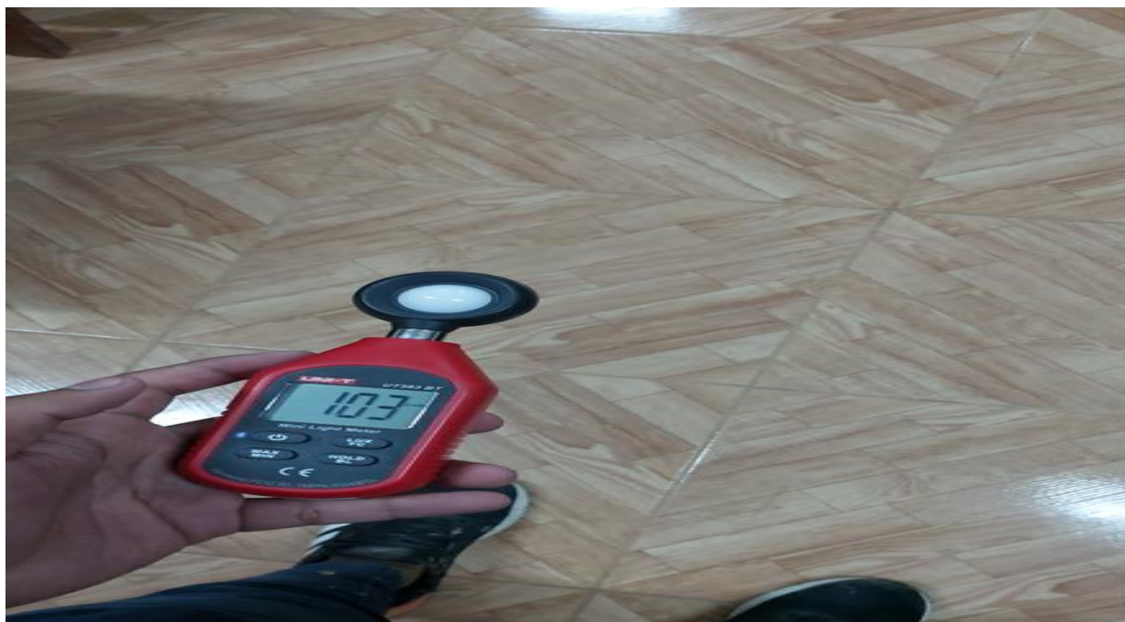
Figura N°60: Resultado del diagnóstico con el Luxómetro del área de Cómputo de la I.E.S.
