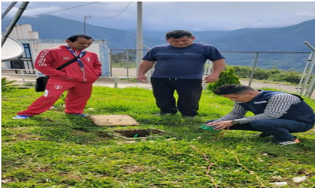
Figura N°52: Realizando el diagnóstico de Resistividad de Ohmios del Pozo Tierra.
