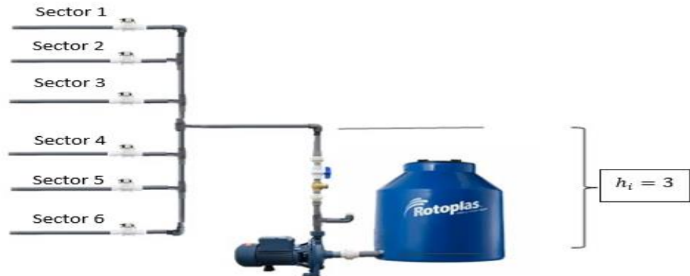
Figura 21. Altura geométrica de los nebulizadores
