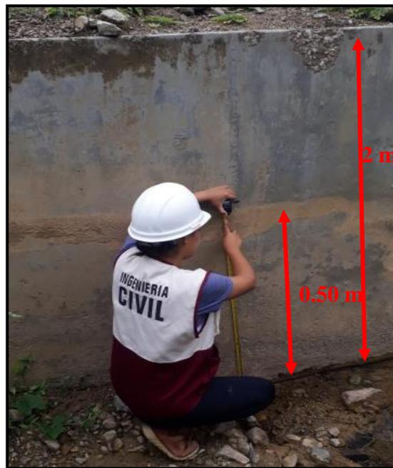
*Nota.* La figura 9, muestra la altura del tirante de agua menor a 0.50 metros y una altura máxima 2 metros.
