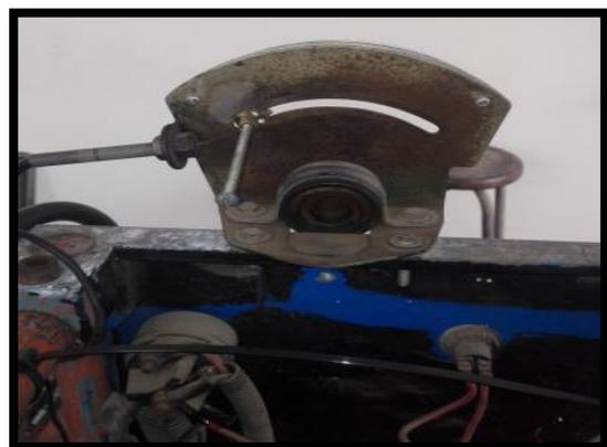
*Figura 18: Regulador de apertura de la válvula mariposa (carga del motor) – IMCI – FIM – Universidad Nacional de Ingeniería*
