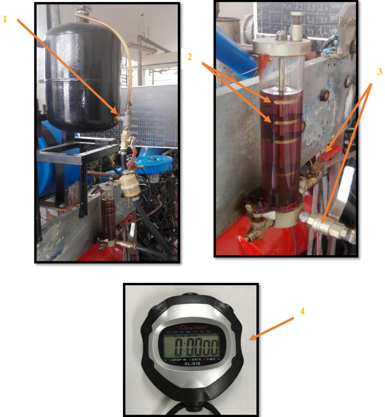
*Figura 12: Sistema usado para el suministro y medición de combustible – IMCI – FIM – Universidad Nacional de Ingeniería*
