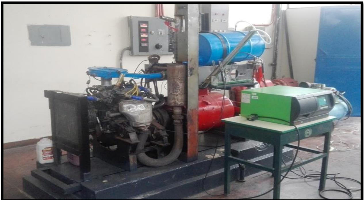
Figura 9: Implementación del Banco de Pruebas utilizado para los ensayos realizados en el IMCI – FIM – Universidad Nacional de Ingeniería
