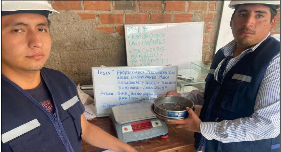
*Nota.* La figura muestra la realización del análisis granulométrico de la cantera Fila alta.
