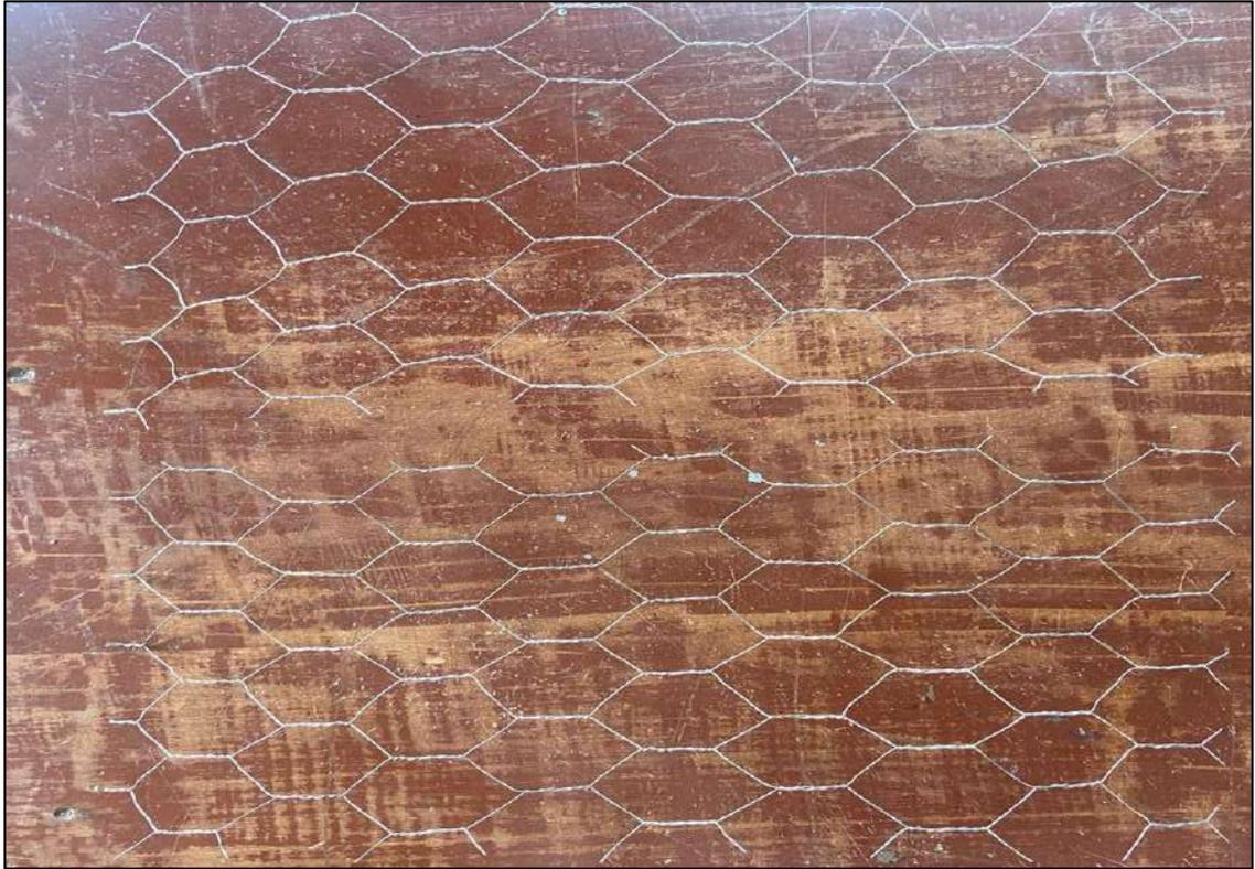
*Nota.* La figura muestra malla hexagonal de 0.15x0.30m para los adobes cúbicos de 0.15mx0.30mx0.12m.
