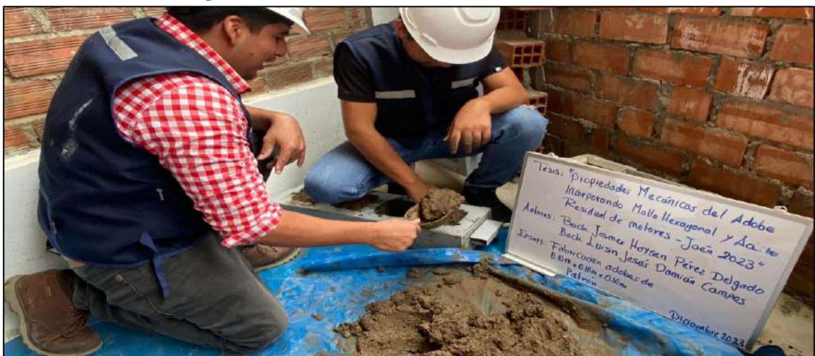
*Nota.* La figura muestra la fabricación de adobes patrón de 0.10mx0.10mx0.10m.
