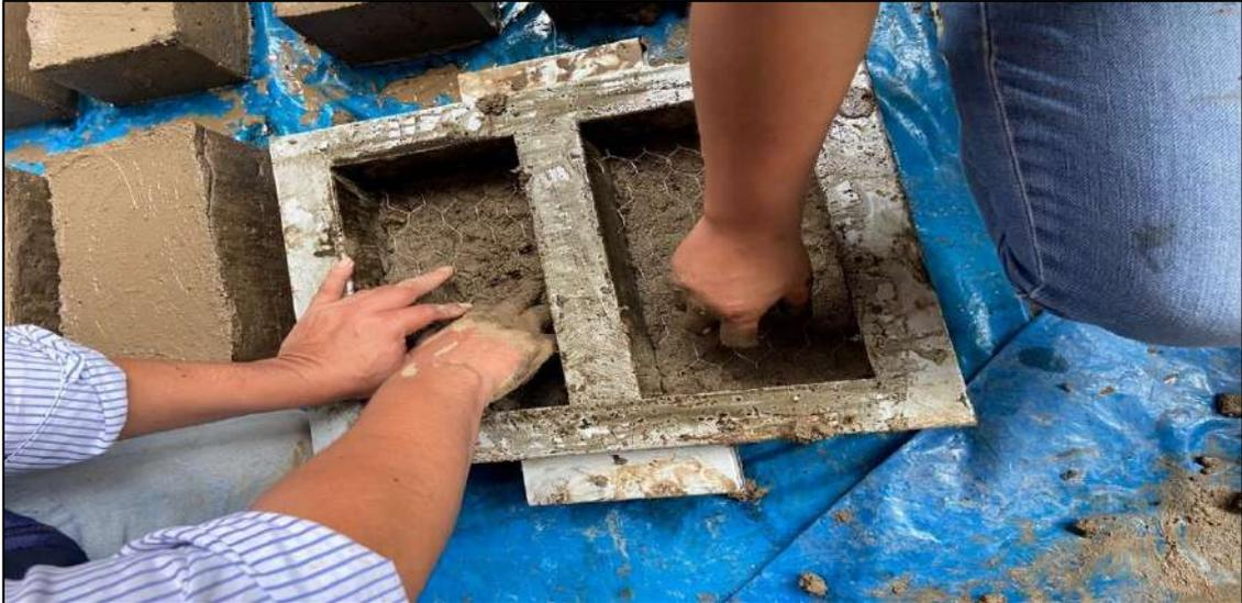
*Nota.* La figura muestra la mezcla de suelo con 1MH+15% ARM para la fabricación de adobes 0.15mx0.30mx0.12m.
