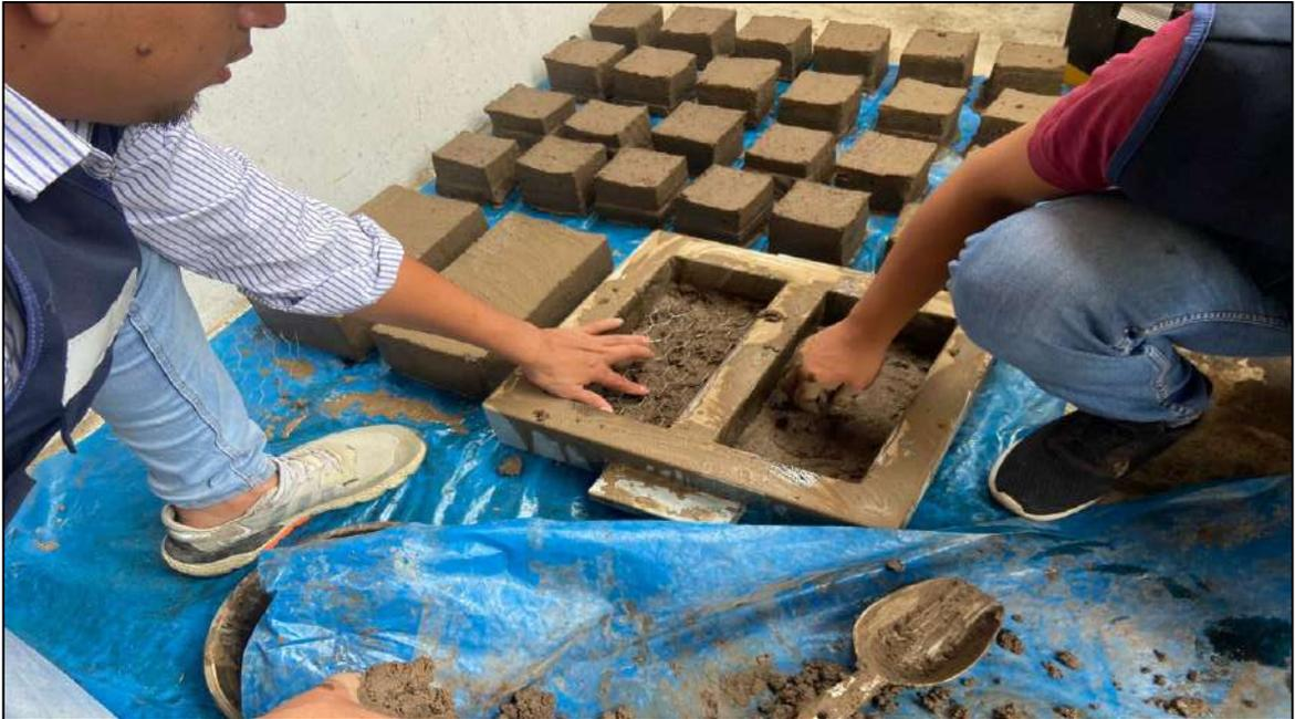
*Nota.* La figura muestra la mezcla de suelo con 1MH+5% ARM para la fabricación de adobes 0.15mx0.30mx0.12m.
