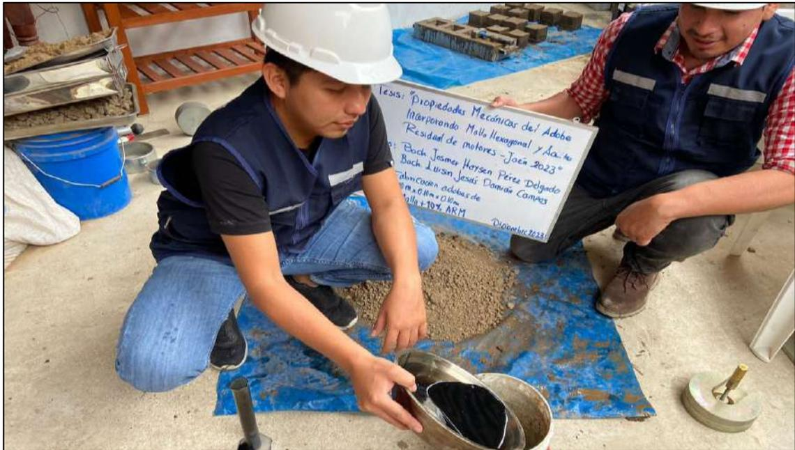
*Nota.* La figura muestra la mezcla de suelo con 10% ARM para la fabricación de adobes 0.10mx0.10mx0.10m.
