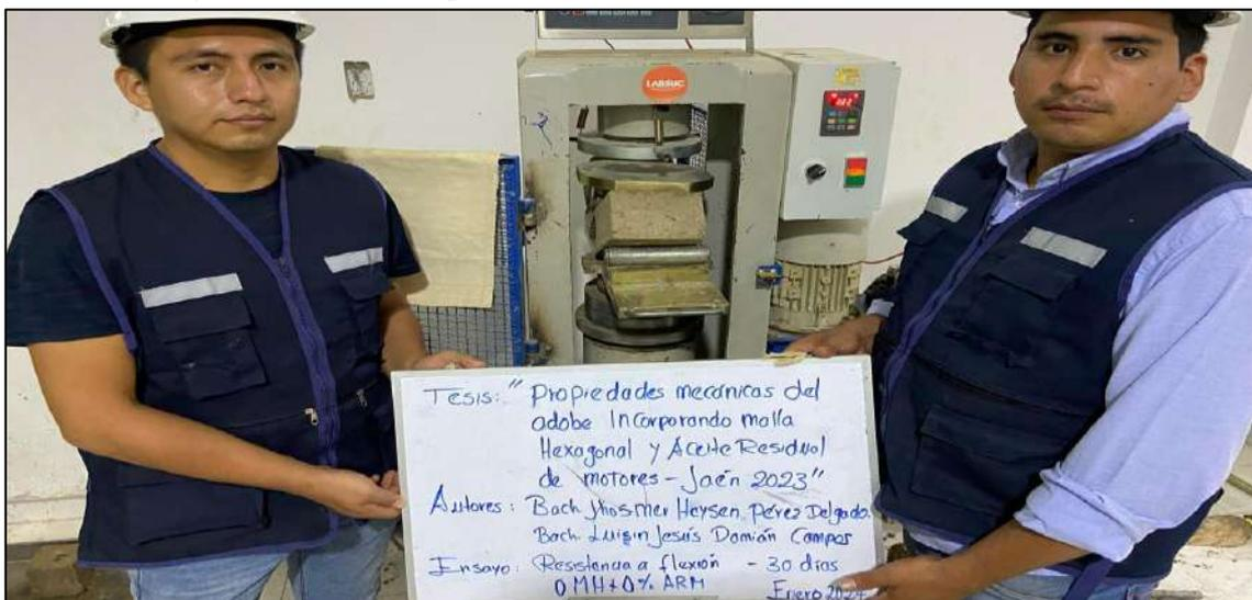
*Nota.* La figura muestra el ensayo de resistencia a flexión del adobe patrón a los 28 días.
