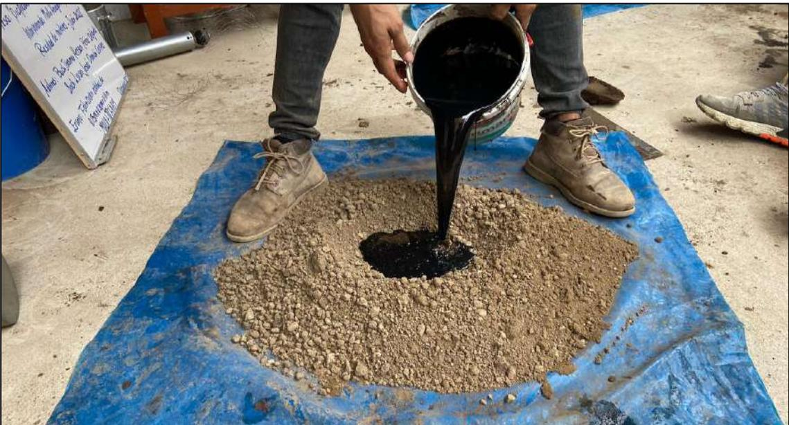
*Nota.* La figura muestra la mezcla de suelo con 10% ARM para la fabricación de adobes 0.15mx0.30mx0.12m.
