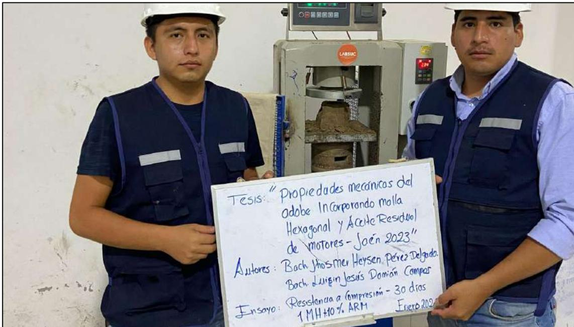
*Nota.* La figura muestra el ensayo de resistencia a compresión del adobe con adición de 1MH + 10% de ARM, a los 28 días.
