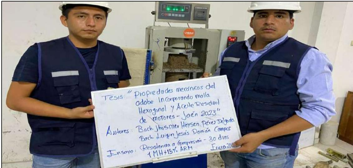
*Nota.* La figura muestra el ensayo de resistencia a compresión del adobe con adición de 1MH + 15% de ARM, a los 28 días.
