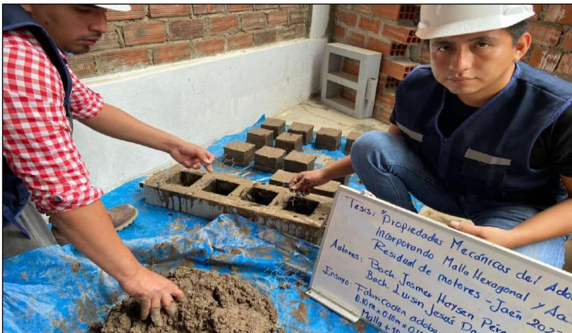
*Nota.* La figura muestra la mezcla de suelo con 1MH + 10% ARM para la fabricación de adobes 0.10mx0.10mx0.10m.
