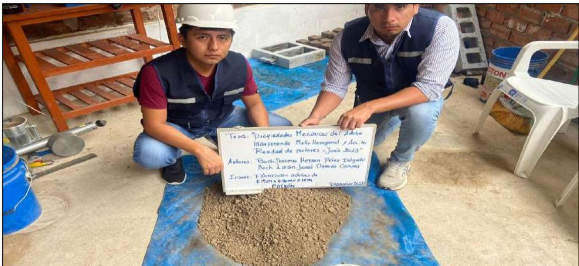
*Nota.* La figura muestra la fabricación de adobes patrón de 0.15mx0.30mx0.12m.
