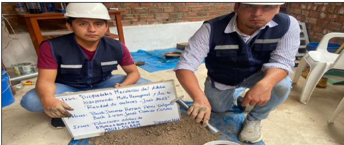
*Nota.* La figura muestra la mezcla de suelo con 5% ARM para la fabricación de adobes 0.15mx0.30mx0.12m.
