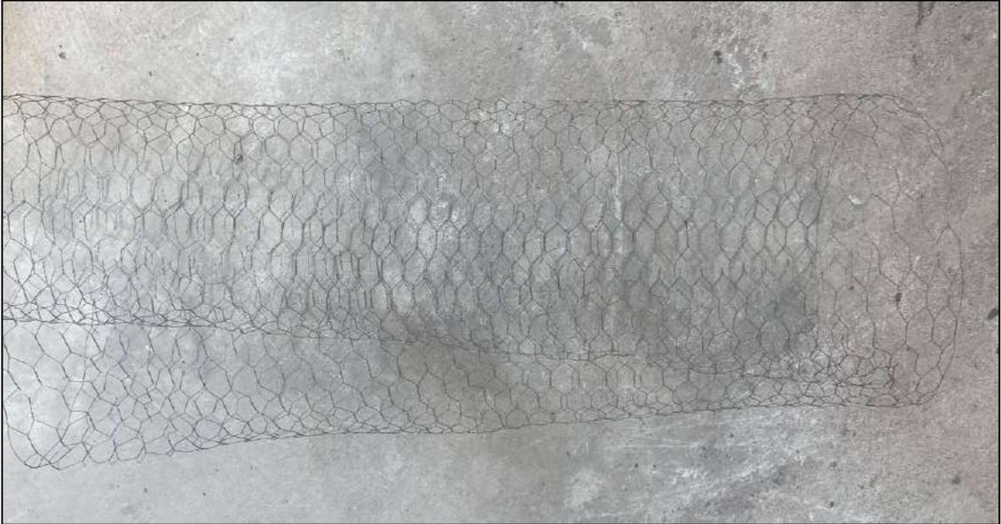
*Nota.* La figura muestra la malla hexagonal de  $\frac{3}{4}$ " N° 28, adquirida.
