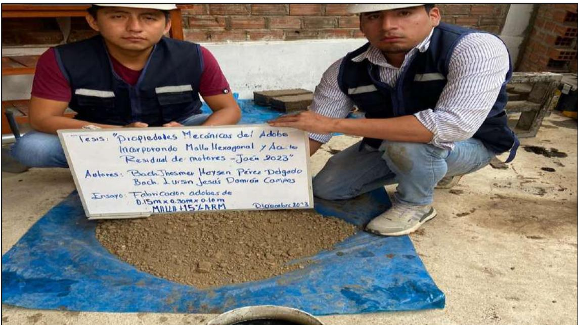
*Nota.* La figura muestra la mezcla de suelo con 15% ARM para la fabricación de adobes 0.15mx0.30mx0.12m.
