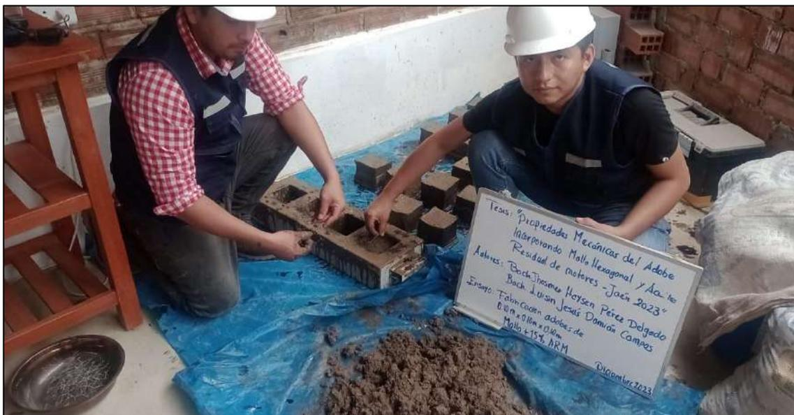
*Nota.* La figura muestra la mezcla de suelo con 1MH + 15% ARM para la fabricación de adobes 0.10mx0.10mx0.10m.
