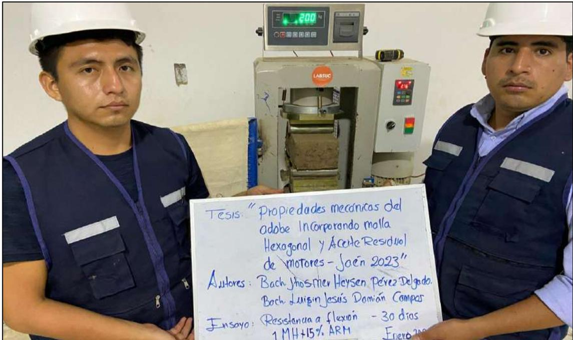
*Nota.* La figura muestra el ensayo de resistencia a flexión del adobe con adición de 1MH + 15% de ARM, a los 28 días.
