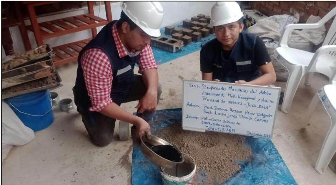
*Nota.* La figura muestra la mezcla de suelo con 15% ARM para la fabricación de adobes 0.10mx0.10mx0.10m.
