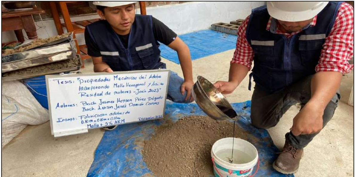
*Nota.* La figura muestra la mezcla de suelo con 5% ARM para la fabricación de adobes 0.10mx0.10mx0.10m.
