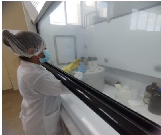
Figura 144: Sellando tubos de teflón.
