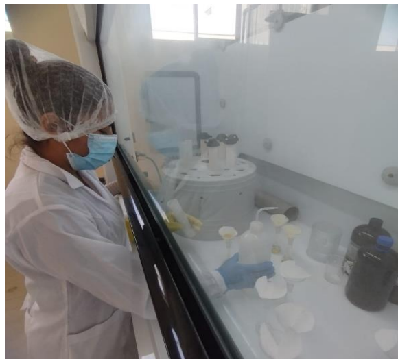
Figura 147: Se extraen del digestor las muestras y pasan hacer filtradas
