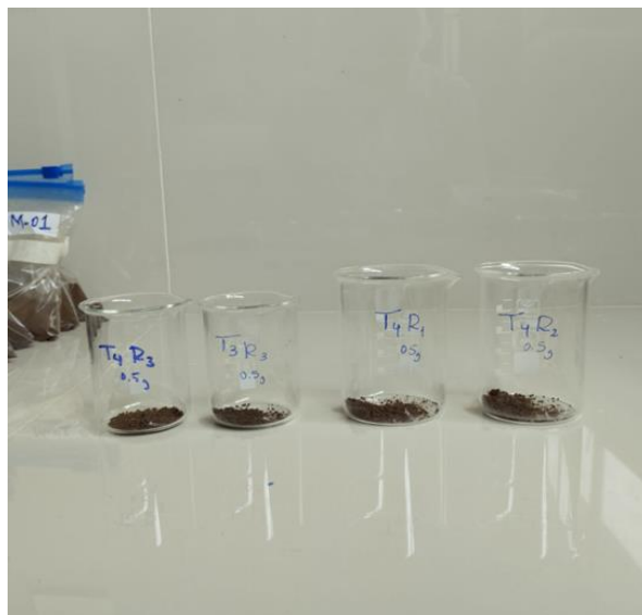
Figura 140: Muestra pesada lista para agregar a los tubos teflón.
