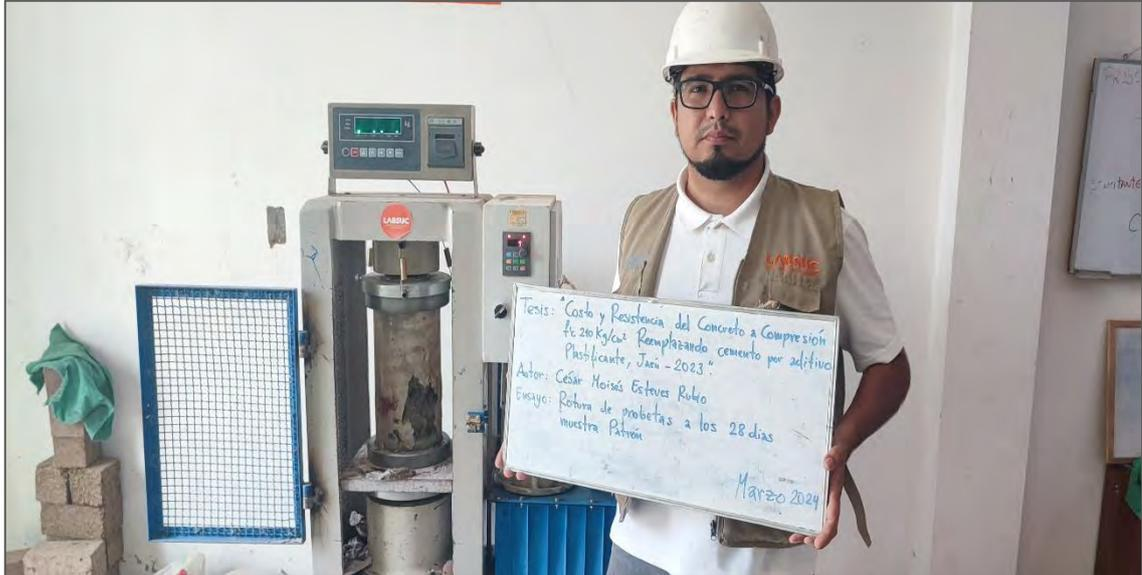
*Nota.* La figura muestra el ensayo de resistencia a compresión del concreto patrón a los 28 días. Fuente: Elaboración propia.
