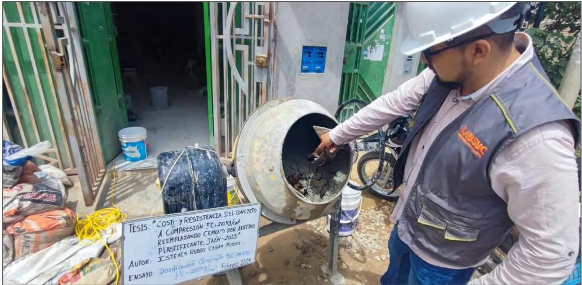
*Nota.* La figura muestra la dosificación de concreto  $f'c=210\text{ kg/cm}^2$ , reemplazando 1% de cemento por 0.5% de aditivo. Fuente: Elaboración propia.
