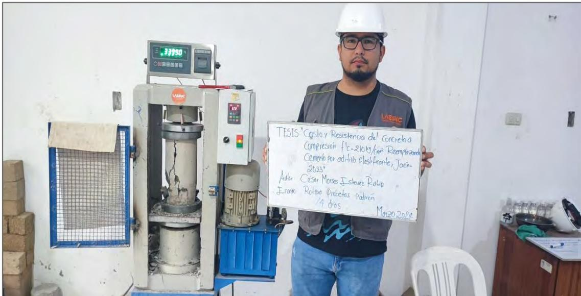
Nota. La figura muestra el ensayo de resistencia a compresión del concreto patrón a los 14 días. Fuente: Elaboración propia.
