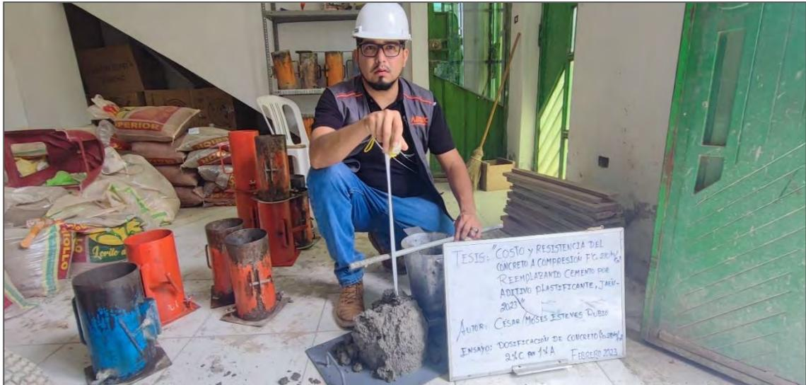
*Nota.* La figura muestra la medición del slump del concreto  $f'c=210\text{ kg/cm}^2$ , reemplazando 2% de cemento por 1% de aditivo. Fuente: Elaboración propia.
