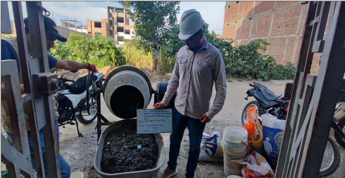
*Nota.* La figura muestra la medición de la temperatura del concreto  $f'c=210\text{ kg/cm}^2$ , reemplazando 3% de cemento por 1.5% de aditivo. Fuente: Elaboración propia.
