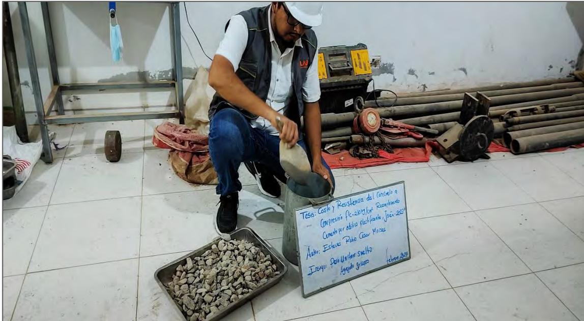
*Nota.* La figura muestra parte de la realización del peso unitario suelto del agregado grueso. Fuente: Elaboración propia.
