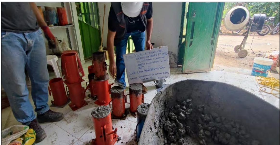
*Nota.* La figura muestra la fabricación de probetas cilíndricas de concreto patrón  $f'c=210\text{ kg/cm}^2$ , reemplazando 2% de cemento por 1% de aditivo. Fuente: Elaboración propia.
