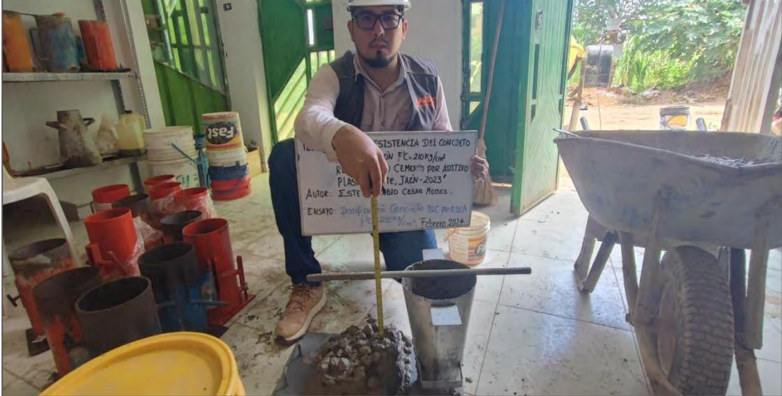
*Nota.* La figura muestra la medición del slump del concreto  $f'c=210\text{ kg/cm}^2$ , reemplazando 1% de cemento por 0.5% de aditivo. Fuente: Elaboración propia.
