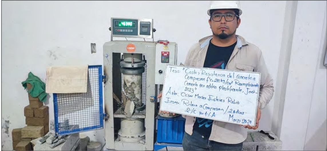
*Nota.* La figura muestra el ensayo de resistencia a compresión del concreto a los 28 días, reemplazando 2% de cemento por 1% de aditivo. Fuente: Elaboración propia.
