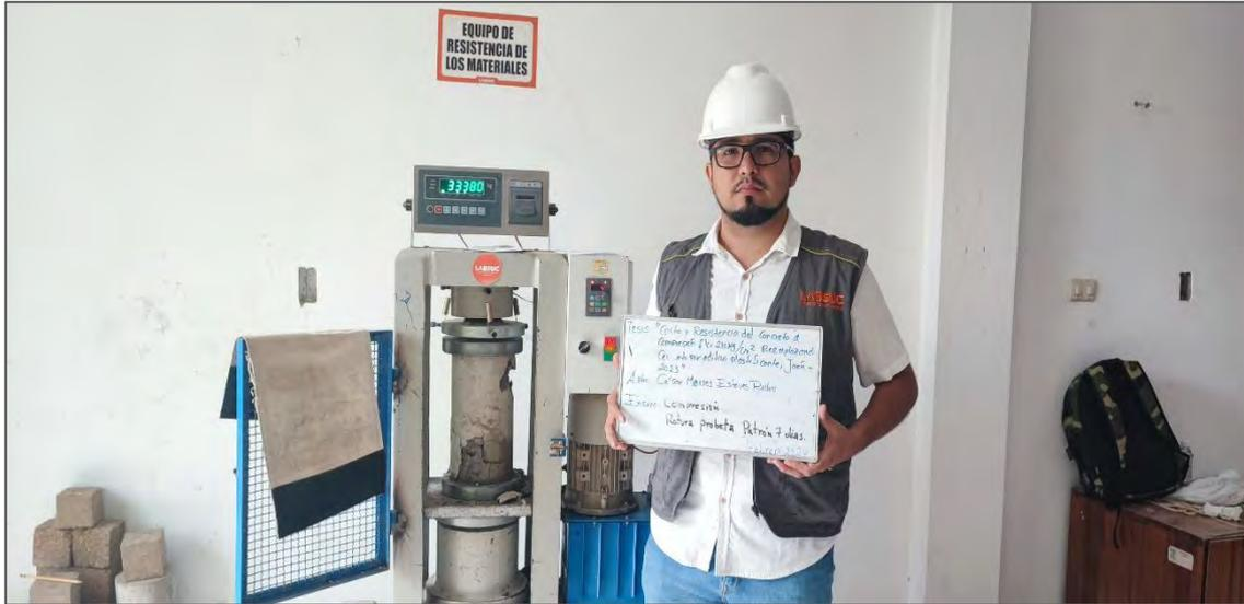
Nota. La figura muestra el ensayo de resistencia a compresión del concreto patrón a los 7 días. Fuente: Elaboración propia.
