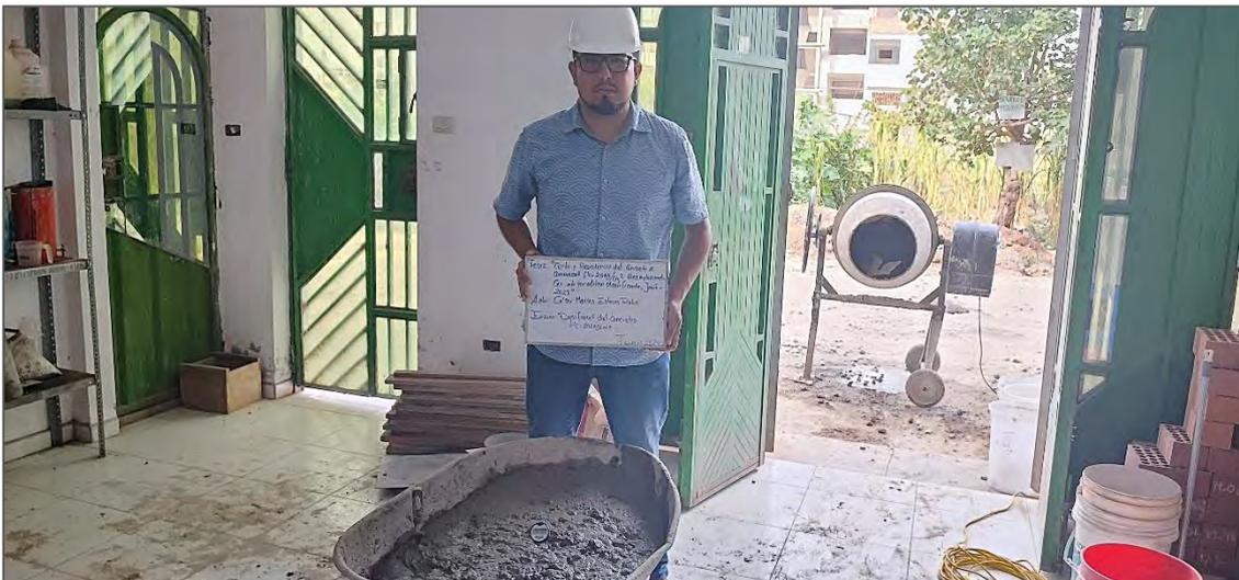
*Nota.* La figura muestra la medición de la temperatura del concreto patrón  $f'c=210\text{ kg/cm}^2$ . Fuente: Elaboración propia.
