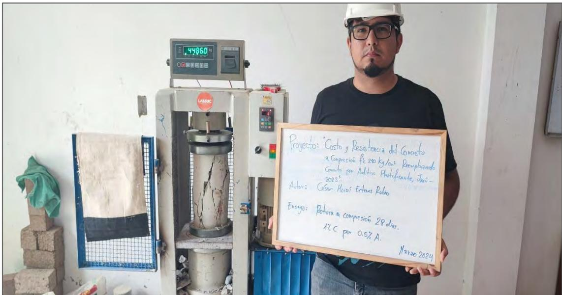
Nota. La figura muestra el ensayo de resistencia a compresión del concreto a los 28 días, reemplazando 1% de cemento por 0.5% de aditivo. Fuente: Elaboración propia.
