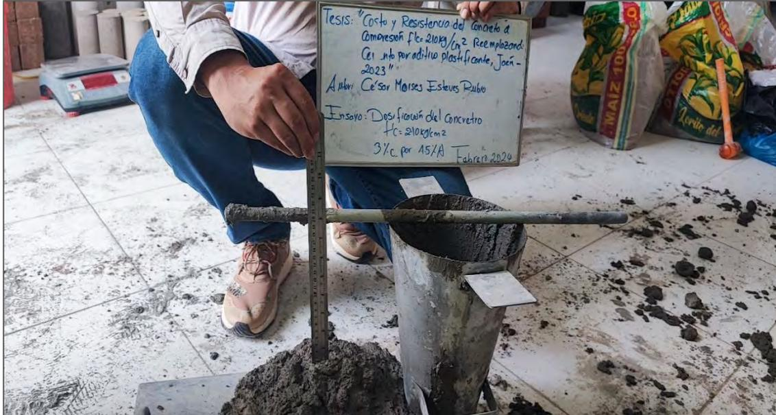
*Nota.* La figura muestra la medición del slump del concreto  $f'c=210\text{ kg/cm}^2$ , reemplazando 3% de cemento por 1.5% de aditivo. Fuente: Elaboración propia.
