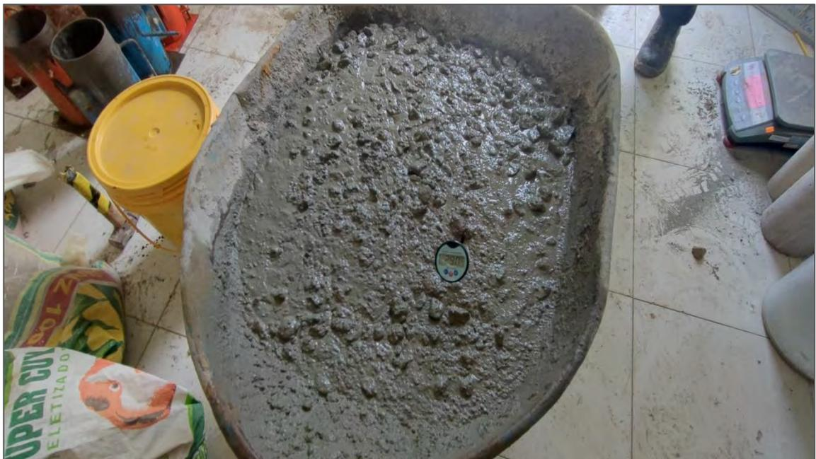
*Nota.* La figura muestra la medición de la temperatura del concreto  $f'c=210\text{ kg/cm}^2$ , reemplazando 1% de cemento por 0.5% de aditivo. Fuente: Elaboración propia.
