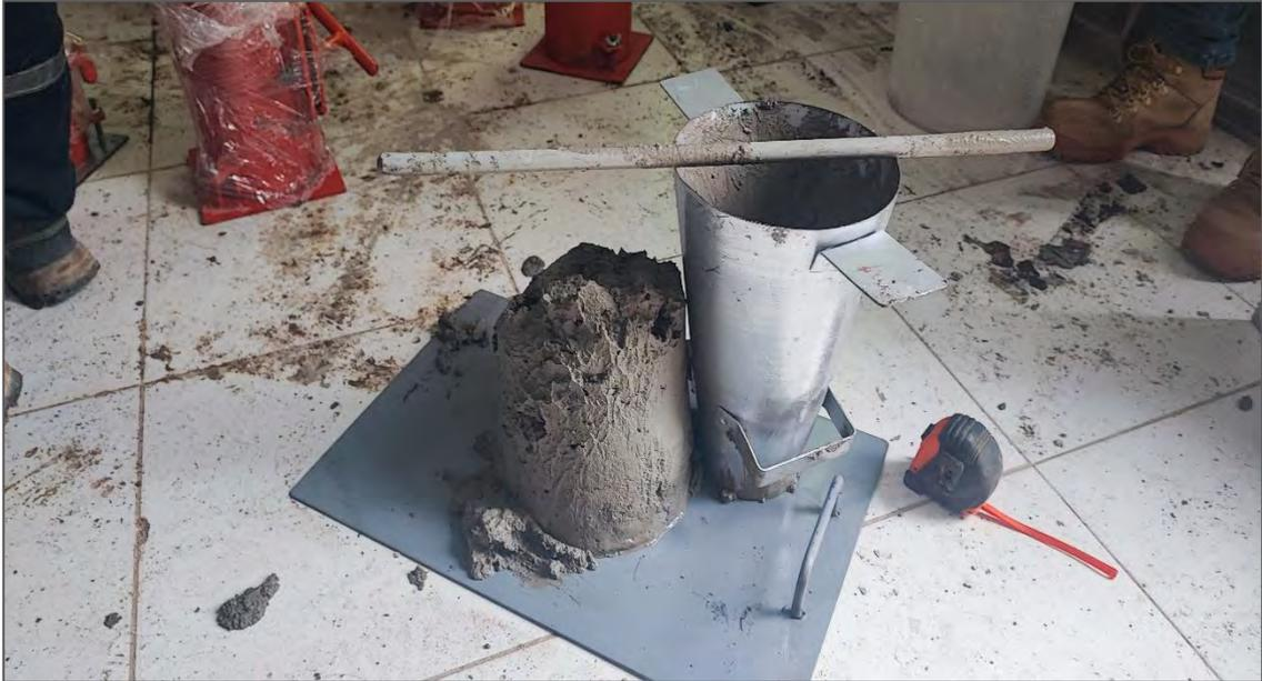
*Nota.* La figura muestra la medición del slump del concreto patrón  $f'c=210\text{ kg/cm}^2$ .
