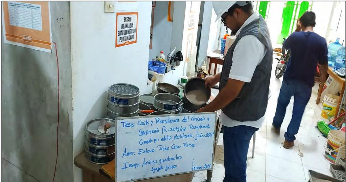
*Nota.* La figura muestra parte de la realización del análisis granulométrico del agregado fino. Fuente: Elaboración propia.
