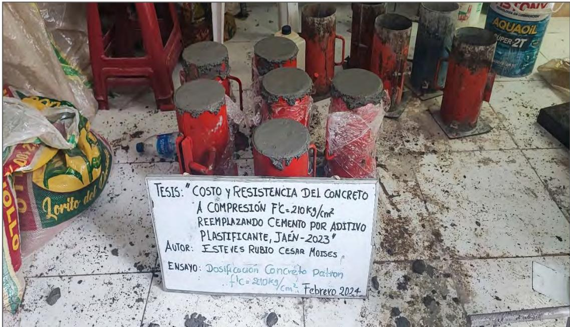
*Nota.* La figura muestra la fabricación de probetas cilíndricas de concreto patrón  $f'c=210\text{ kg/cm}^2$ . Fuente: Elaboración propia.
