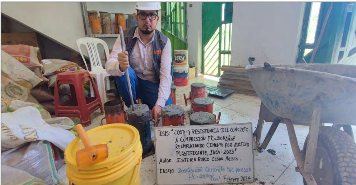
*Nota.* La figura muestra la fabricación de probetas cilíndricas de concreto  $f'c=210\text{ kg/cm}^2$ , reemplazando 1% de cemento por 0.5% de aditivo. Fuente: Elaboración propia.
