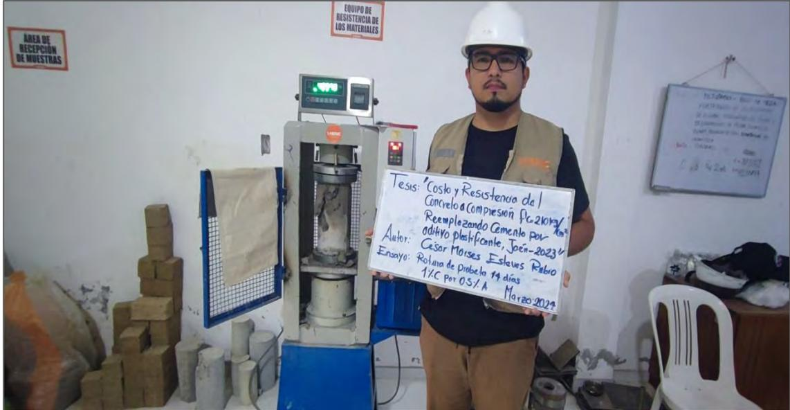
Nota. La figura muestra el ensayo de resistencia a compresión del concreto a los 14 días, reemplazando 1% de cemento por 0.5% de aditivo. Fuente: Elaboración propia.
