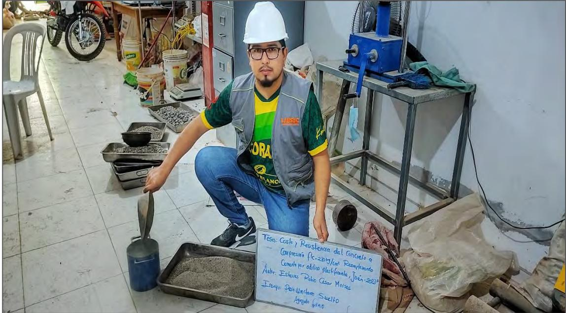
*Nota.* La figura muestra parte de la realización del peso unitario suelto del agregado fino. Fuente: Elaboración propia.
