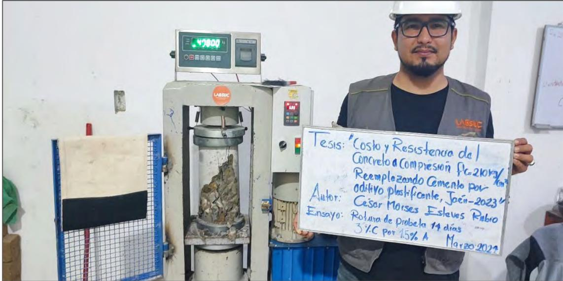
*Nota.* La figura muestra el ensayo de resistencia a compresión del concreto a los 14 días, reemplazando 3% de cemento por 1.5% de aditivo. Fuente: Elaboración propia.
