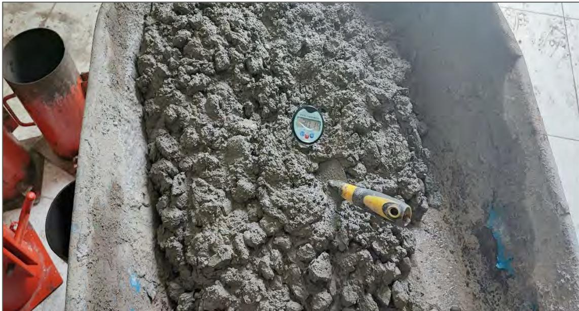
*Nota.* La figura muestra la medición de la temperatura del concreto  $f'c=210\text{ kg/cm}^2$ , reemplazando 2% de cemento por 1% de aditivo. Fuente: Elaboración propia.
