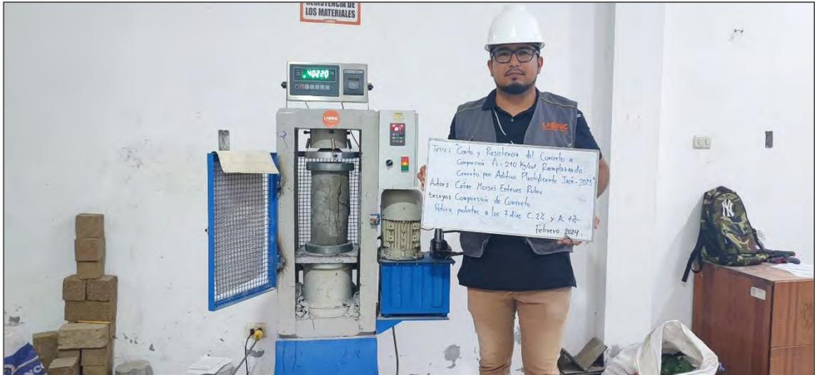
*Nota.* La figura muestra el ensayo de resistencia a compresión del concreto a los 7 días, reemplazando 2% de cemento por 1% de aditivo. Fuente: Elaboración propia.
