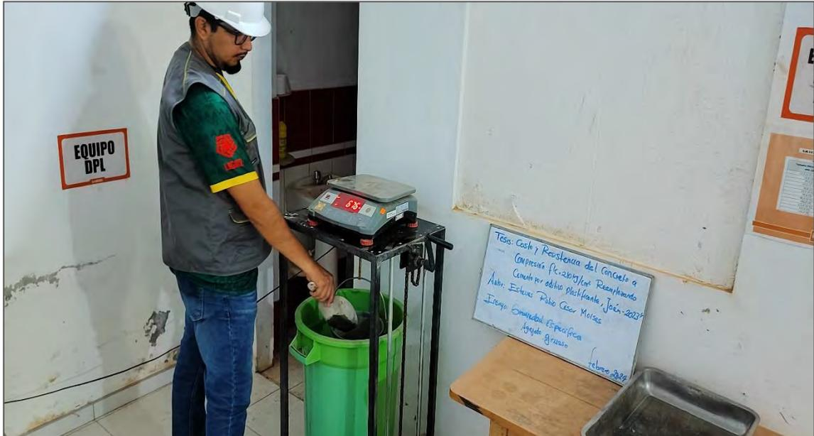
*Nota.* La figura muestra parte de la realización del peso específico del agregado grueso.
