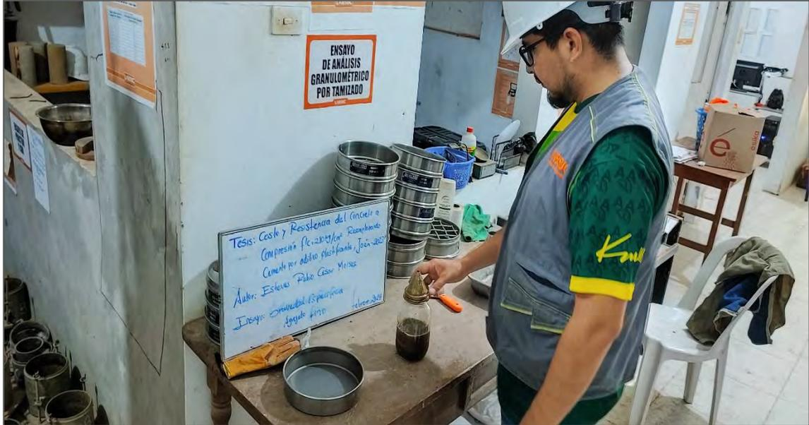
*Nota.* La figura muestra parte de la realización del peso específico del agregado fino.
