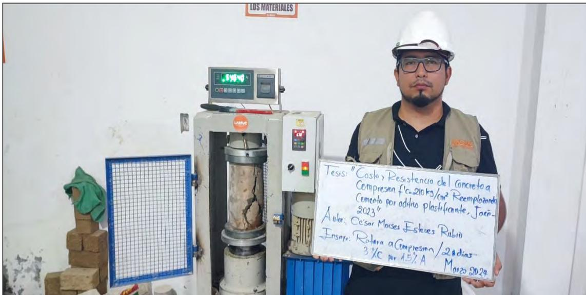
*Nota.* La figura muestra el ensayo de resistencia a compresión del concreto a los 28 días, reemplazando 3% de cemento por 1.5% de aditivo. Fuente: Elaboración propia.
