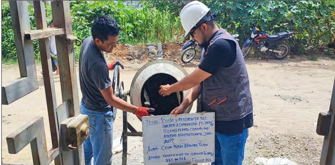
*Nota.* La figura muestra la dosificación de concreto  $f'c=210\text{ kg/cm}^2$ , reemplazando 2% de cemento por 1% de aditivo. Fuente: Elaboración propia.
