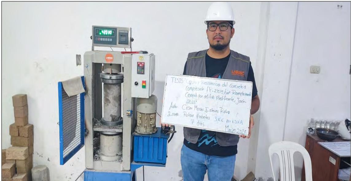
*Nota.* La figura muestra el ensayo de resistencia a compresión del concreto a los 7 días, reemplazando 3% de cemento por 1.5% de aditivo. Fuente: Elaboración propia.
