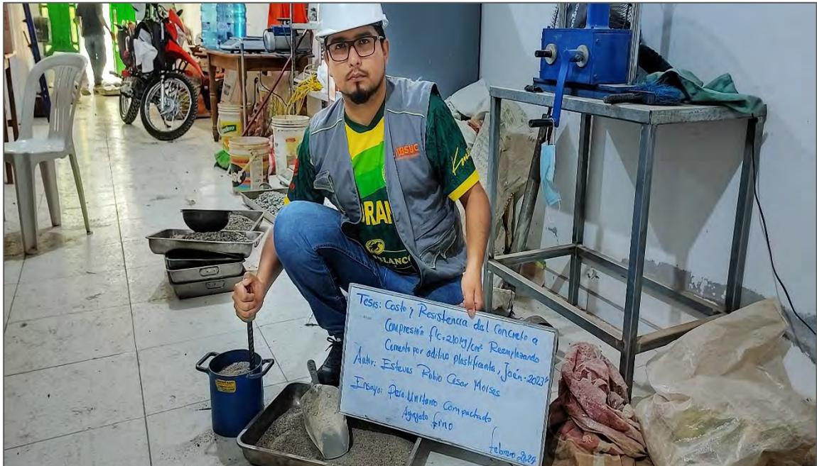
*Nota.* La figura muestra parte de la realización de peso unitario compactado del agregado fino. Fuente: Elaboración propia.
