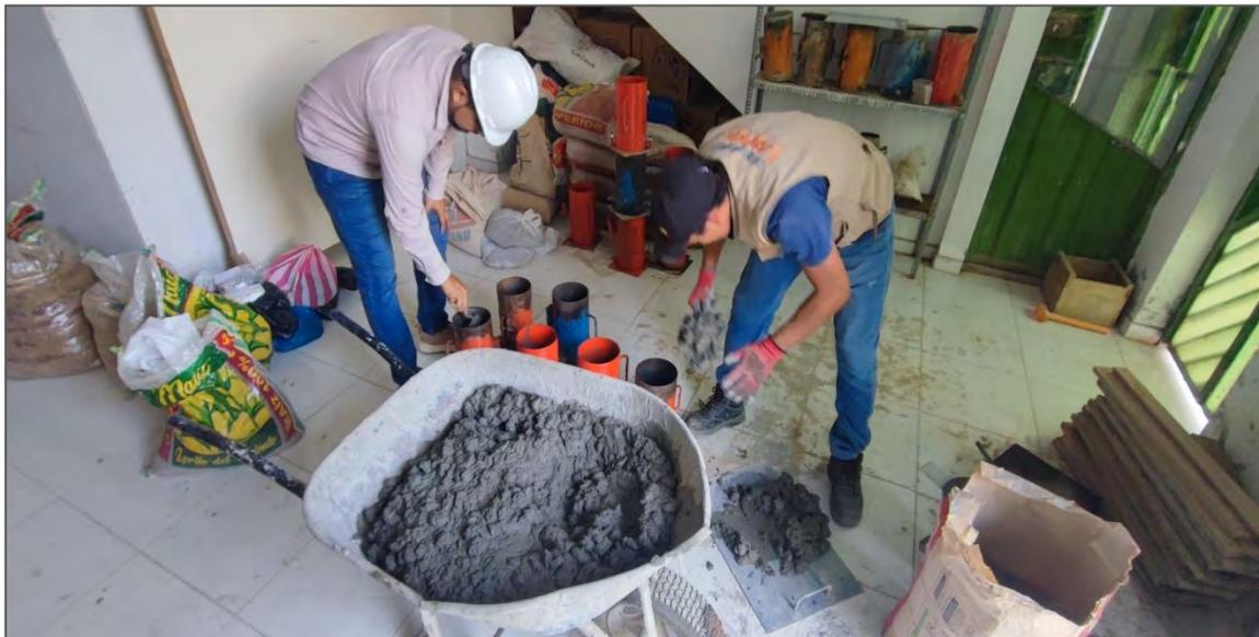
*Nota.* La figura muestra la fabricación de probetas cilíndricas de concreto  $f'c=210\text{ kg/cm}^2$ , reemplazando 3% de cemento por 1.5% de aditivo. Fuente: Elaboración propia.
