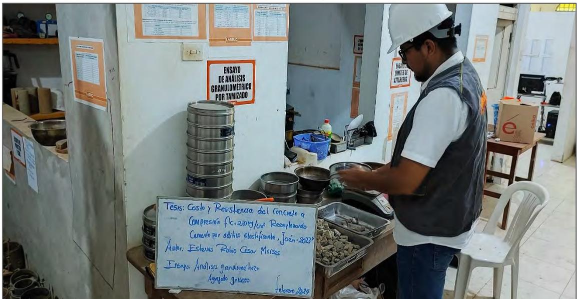
*Nota.* La figura muestra parte de la realización del análisis granulométrico del agregado grueso. Fuente: Elaboración propia.
