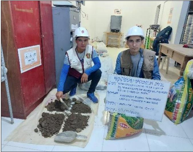
*Nota:* En la figura 5, se muestra el proceso de cuarteo de la muestra de suelo para reducción a tamaño de ensayo en laboratorio, de la muestra de suelo de la calicata N° 1.
