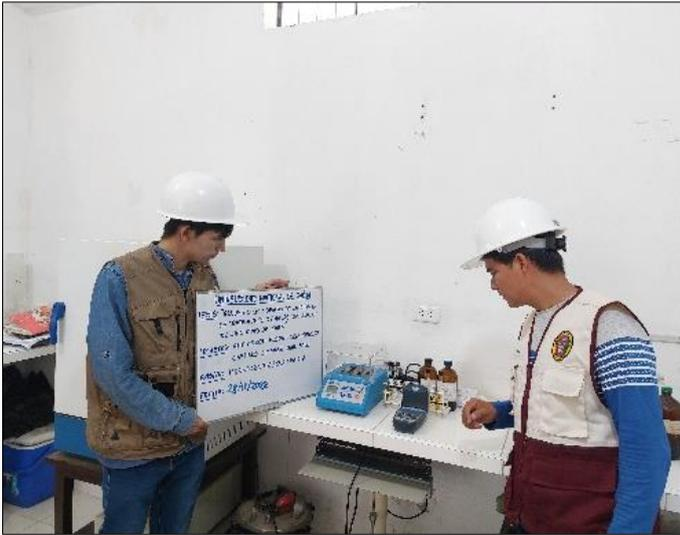
*Nota:* En la figura 11, se muestra el procedimiento del ensayo para determinar la DQO del agua tratada.
