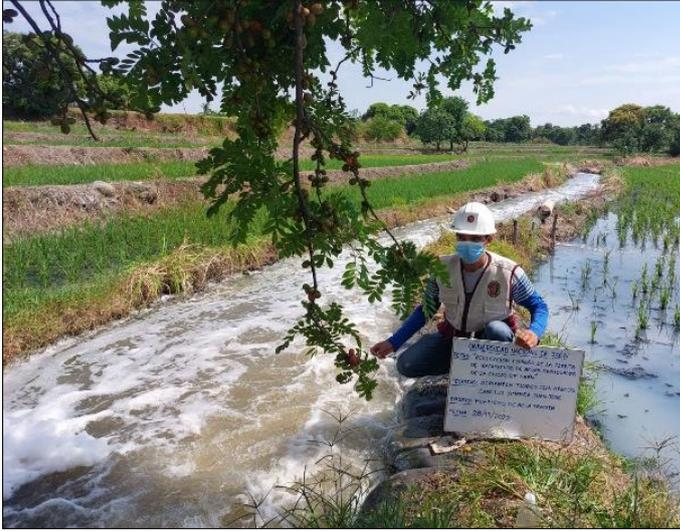
*Nota:* En la figura 9, se muestra el proceso de muestreo de agua a contra corriente del agua efluente de una de las lagunas de oxidación.
