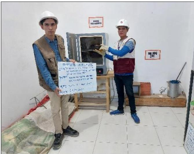
*Nota:* en la figura 6, se muestra el proceso de introducción de las muestras de suelo de la calicata N° 2 en el horno para el secado durante 24 horas.
