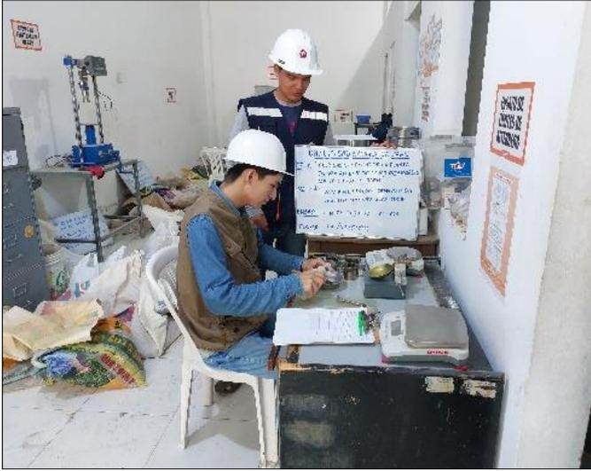
*Nota:* En la figura 7, se presenta el proceso de realización de ensayo para determinar el límite líquido de la muestra de suelo de la calicata N° 1.
