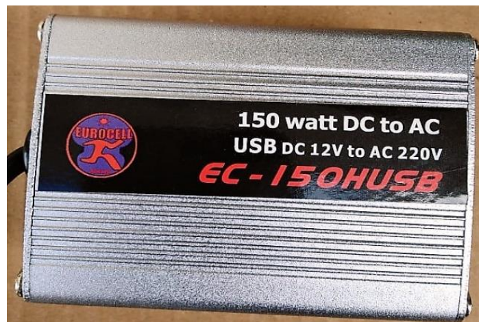
Figura 6. Inversor de 150 W, modelo EC-150 HUSB.
