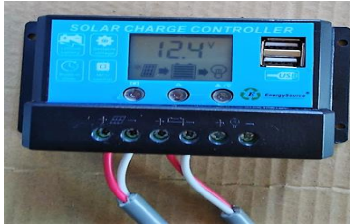
Figura 10. Conexión del panel solar al regulador.
