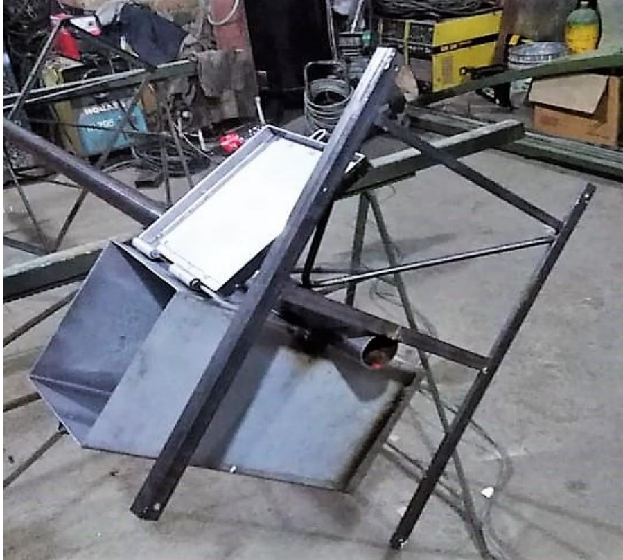
Figura 21. Instalación de caja rectangular para alojar la batería, regulador e inversor.
