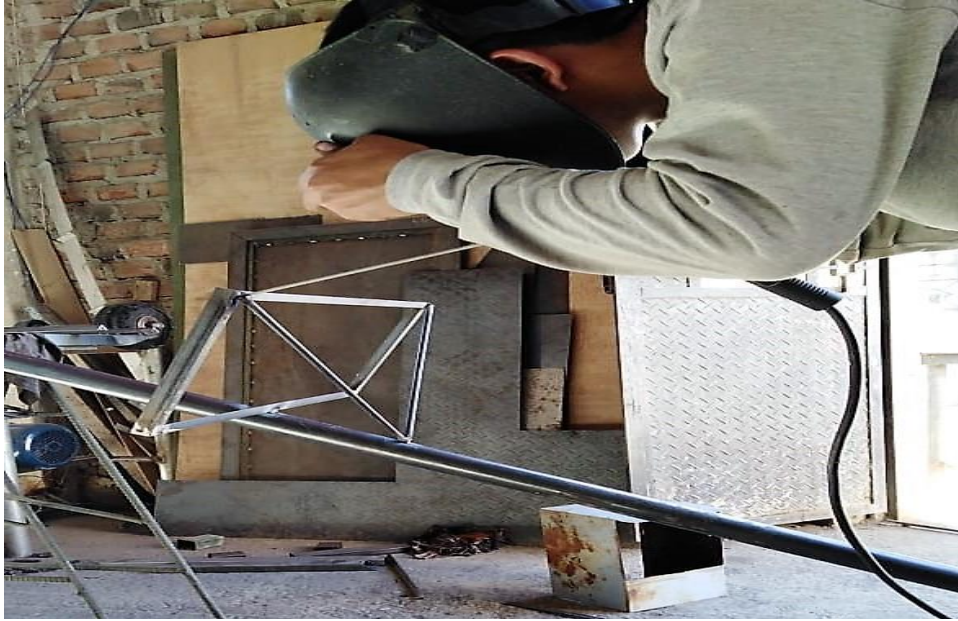
Figura 19. Realización de la soldadura del soporte de la laptop y celular.
