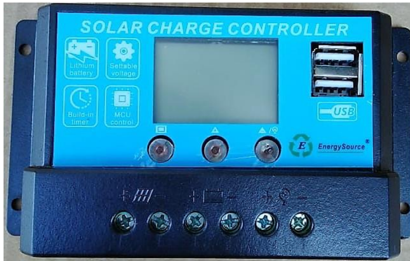
Figura 5. Regulador de carga de 10 A.
