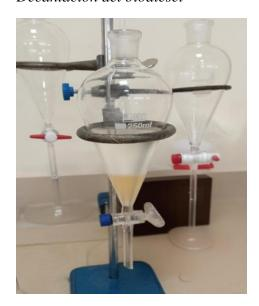
**Figura 26**Separación de la glicerina del biodiesel
