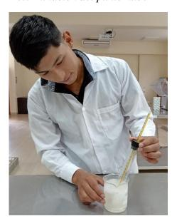
**Figura 36**Determinación del punto de inflamación
