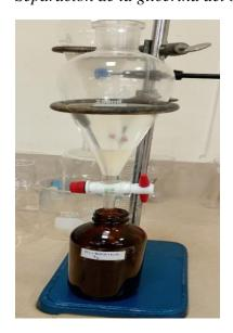
**Figura 27**Purificado del biodiesel
