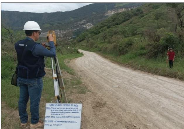
*Nota:* En la figura 5, se muestra la realización del levantamiento topográfico.
