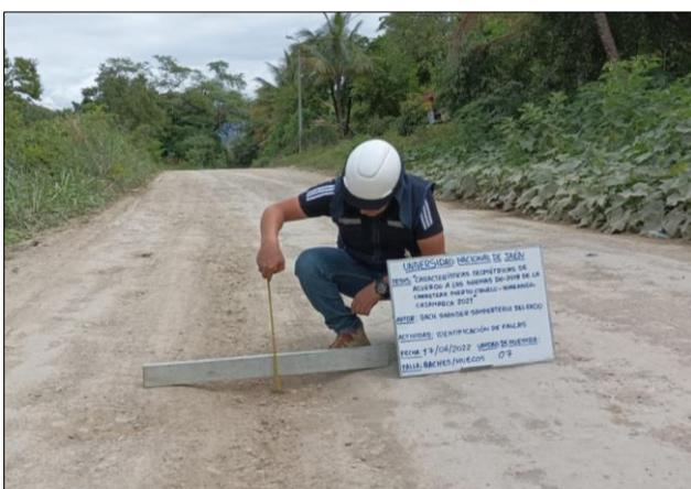
*Nota:* En la figura 1, se presenta el proceso de medición de la profundidad de la falla conocida como “huevo” observada en la unidad de muestra N° 7.
