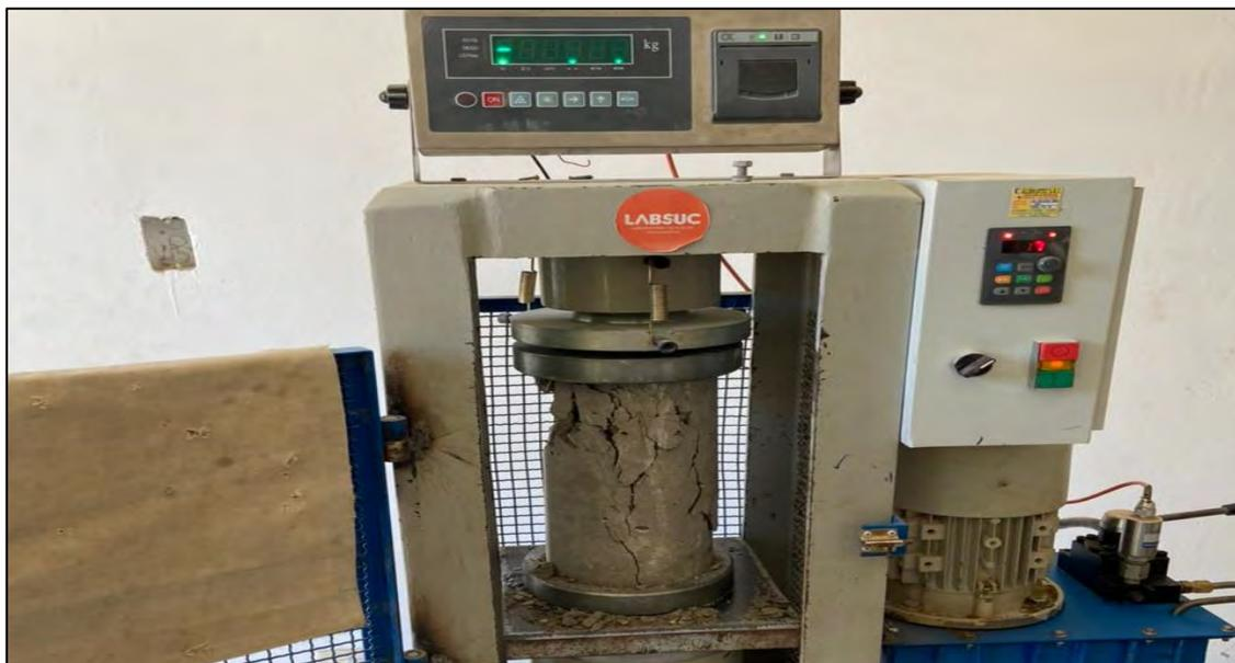
*Nota.* Se muestra la rotura de probeta después de 28 días.
