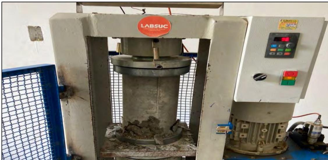
*Nota.* Se muestra la rotura de probeta a los 7 días, con 0.1% fibras.
