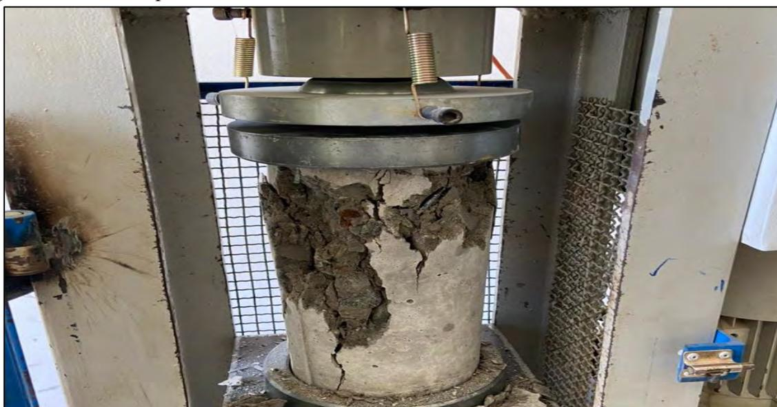
*Nota.* Se muestra la rotura de probeta a los 7 días, con 0.3% fibras.
