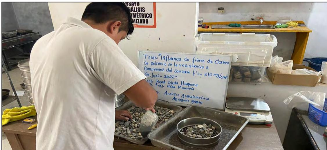
*Nota.* Se muestra el tamizado del agregado grueso.
