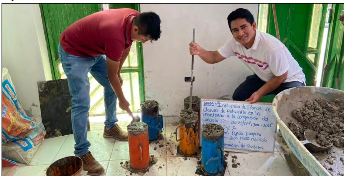
*Nota.* Se muestra las probetas con 0.2% fibras.
