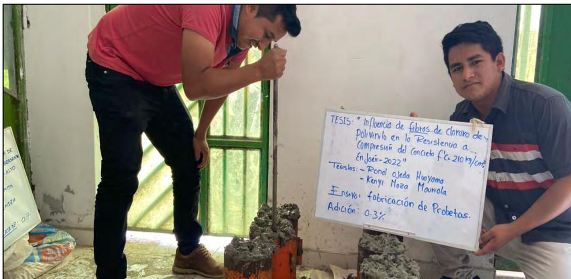
*Nota.* Se muestra el varillado de probetas con 0.3% fibras.
