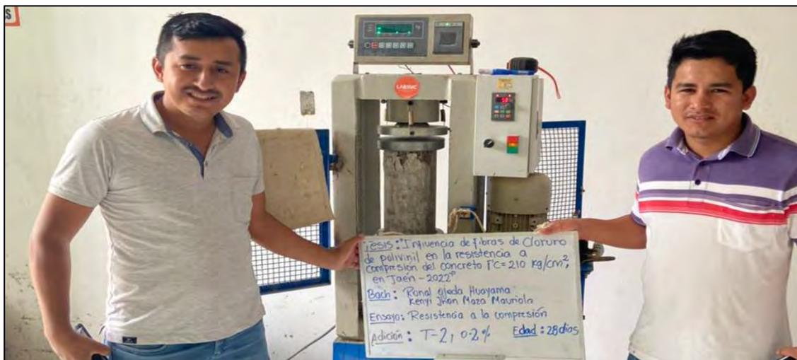
*Nota.* Se muestra la rotura de probeta a los 28 días, con 0.2% fibras.
