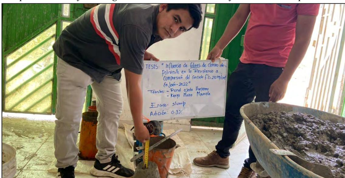
*Nota.* Se muestra la medición del slump con 0.3% fibras.
