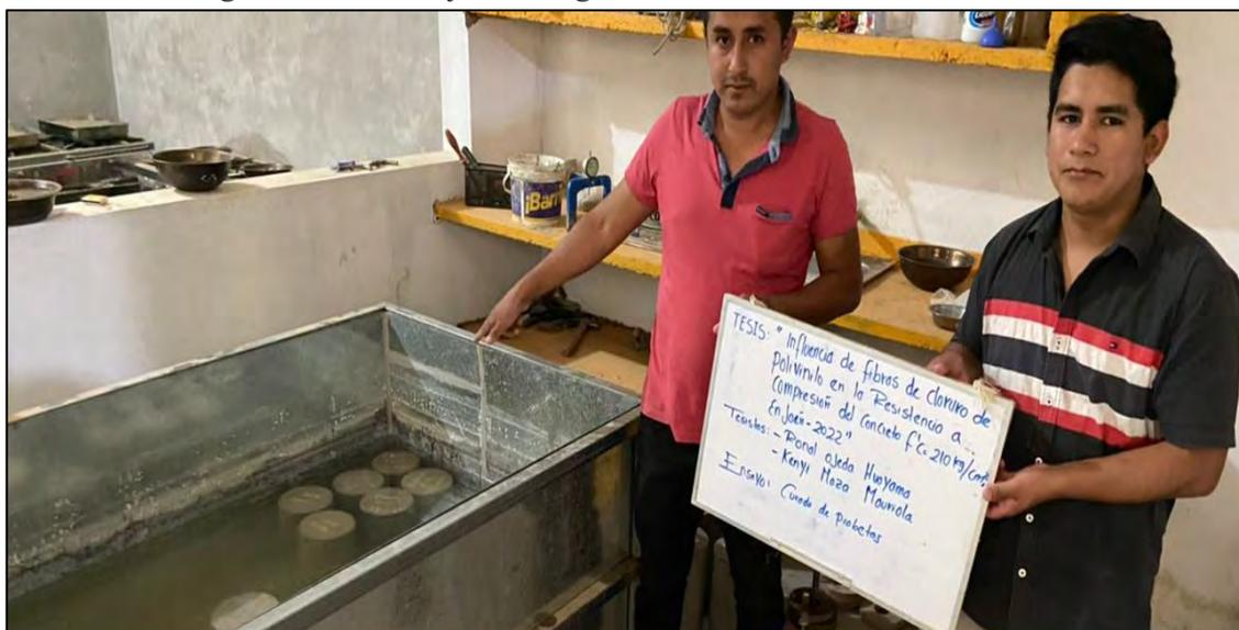
*Nota.* Se muestra inmersión de probetas en agua.
