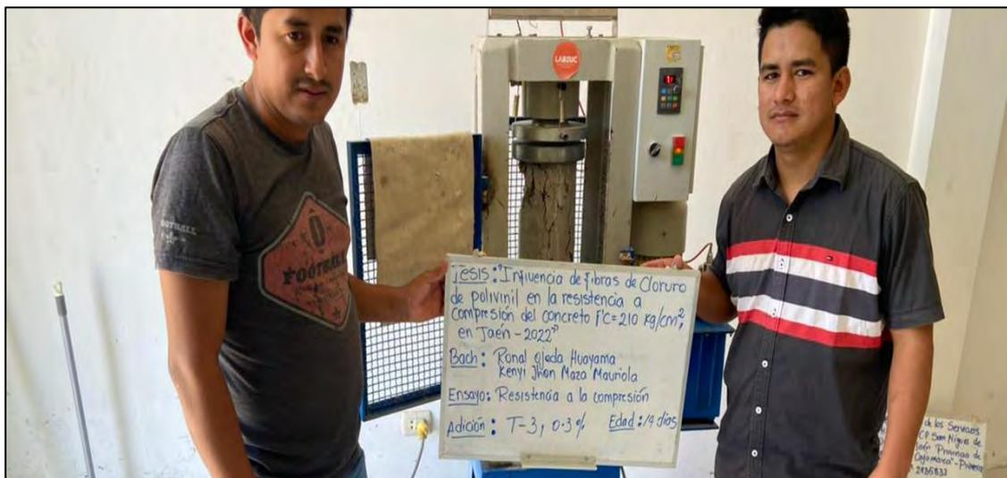
*Nota.* Se muestra la rotura de probeta a los 14 días, con 0.3% fibras.
