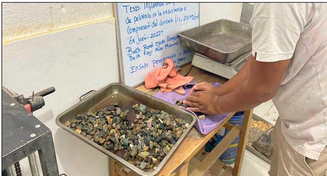
*Nota.* Se muestra el secado superficial del agregado grueso.
