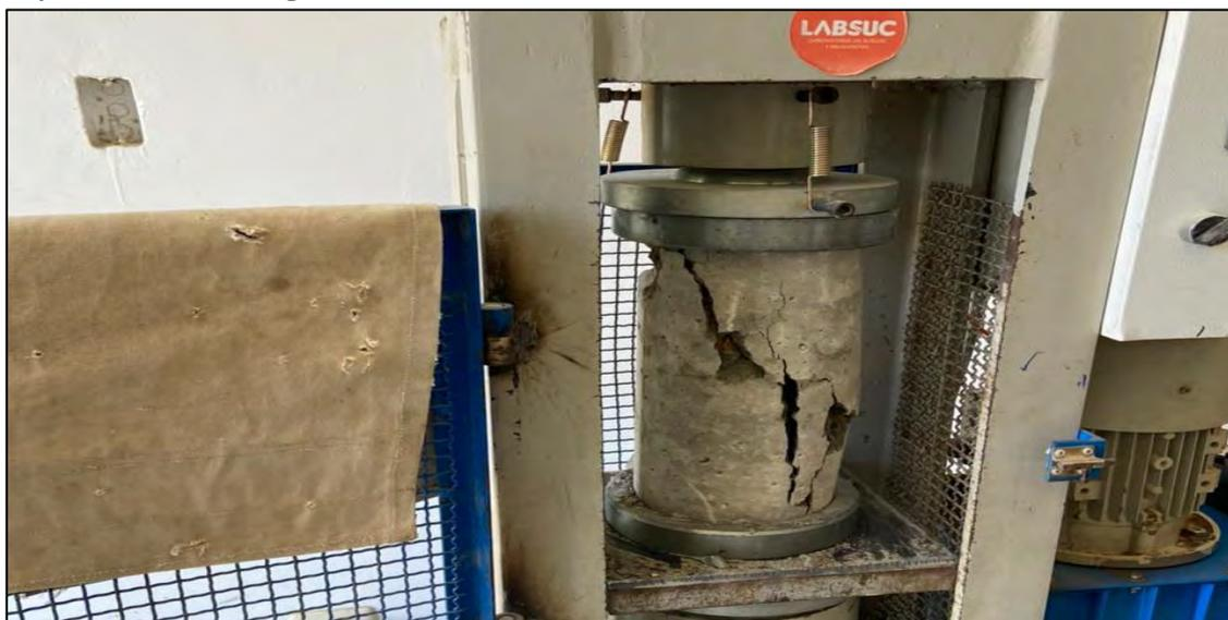
*Nota.* Se muestra la rotura de probeta a los 28 días, con 0.3% fibras.
