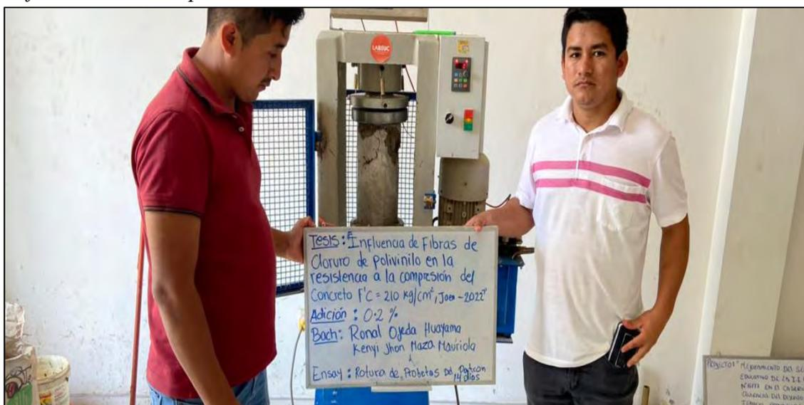
*Nota.* Se muestra la rotura de probeta a los 14 días, con 0.2% fibras.
