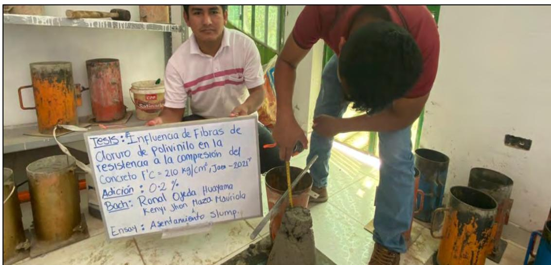
*Nota.* Se muestra la medición del slump con 0.2% fibras.
