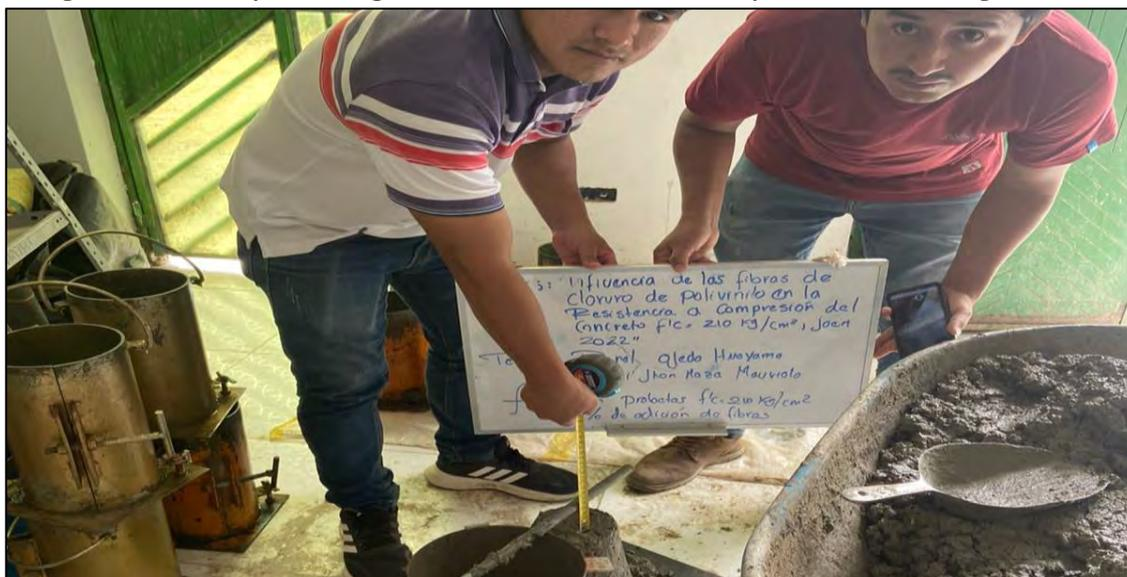
*Nota.* Se muestra la medición del slump con 0.1% fibras.
