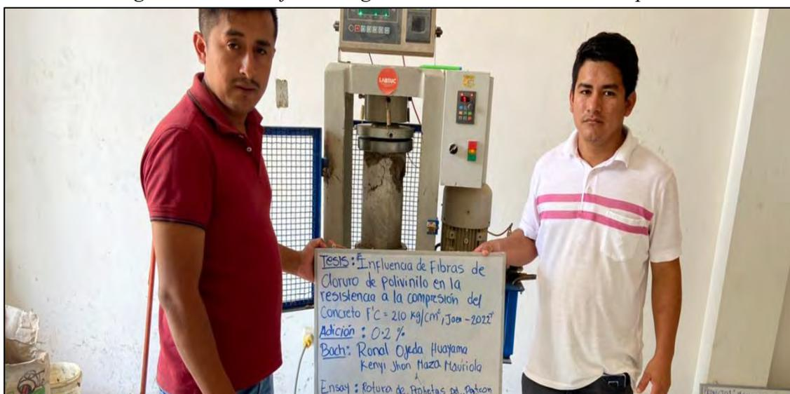
*Nota.* Se muestra la rotura de probeta después de 14 días.
