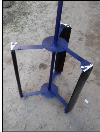
Rotor de la turbina
