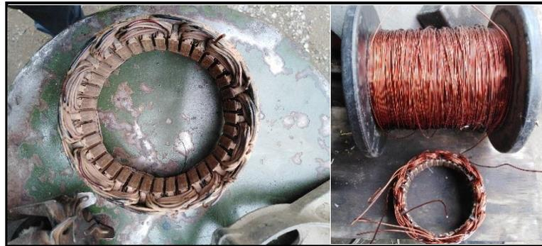
Figura 27. Modificación del estator
