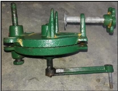
Mecanismo amplificador de RPM
