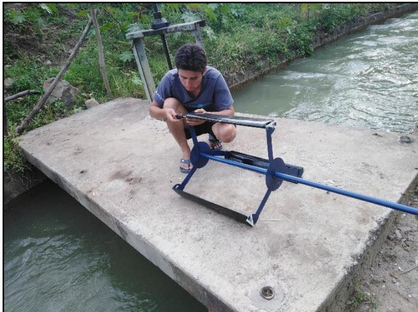
*Figura 28.* Ensamble del rotor
