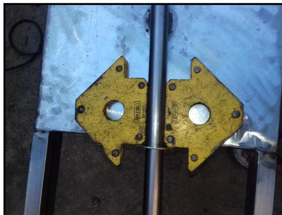
centrado del disco de sujeción en el eje
