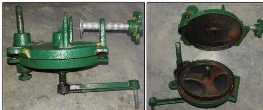
*Figura 22.* Amplificador de RPM
