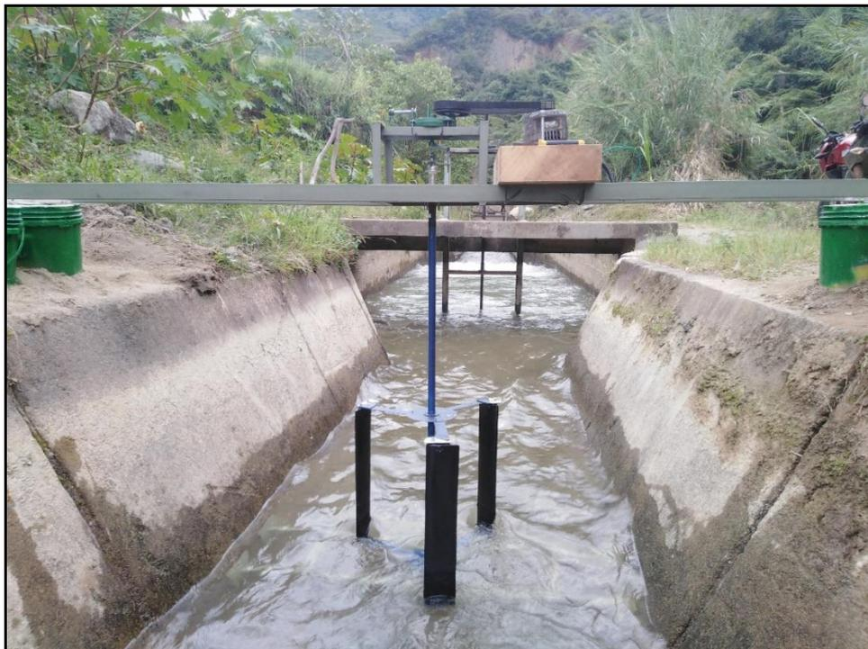
*Figura 32.* Prototipo turbina Darrieus H
