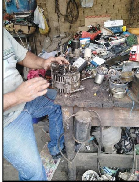
Prueba del puente de diodos
