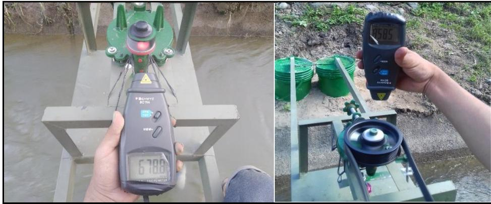
*Figura 33.* Medición de RPM
