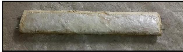
*Figura 13.* Molde de álabe para fabricación en fibra de vidrio
