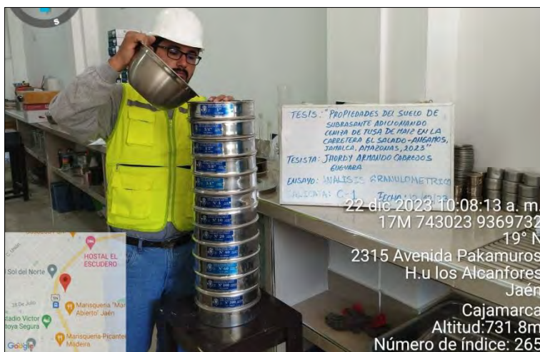
Tamizado de la muestra de suelo de la calicata N° 1
