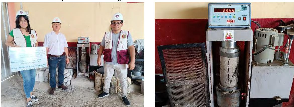
*Nota.* La figura muestra la rotura de especímenes de concreto. Fuente: Normativa NTP 339.183.
