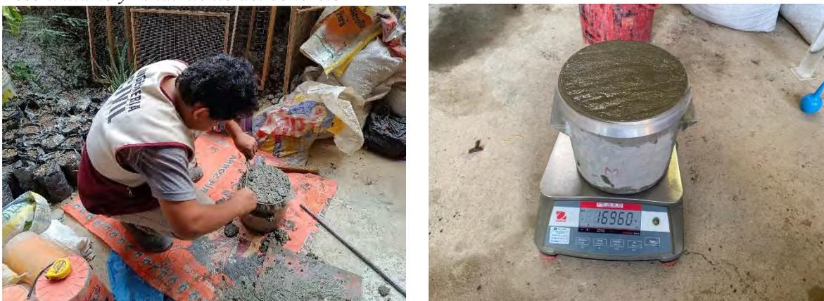
*Nota.* La figura muestra el peso unitario del concreto. Fuente: Normativa NTP 339.046.
