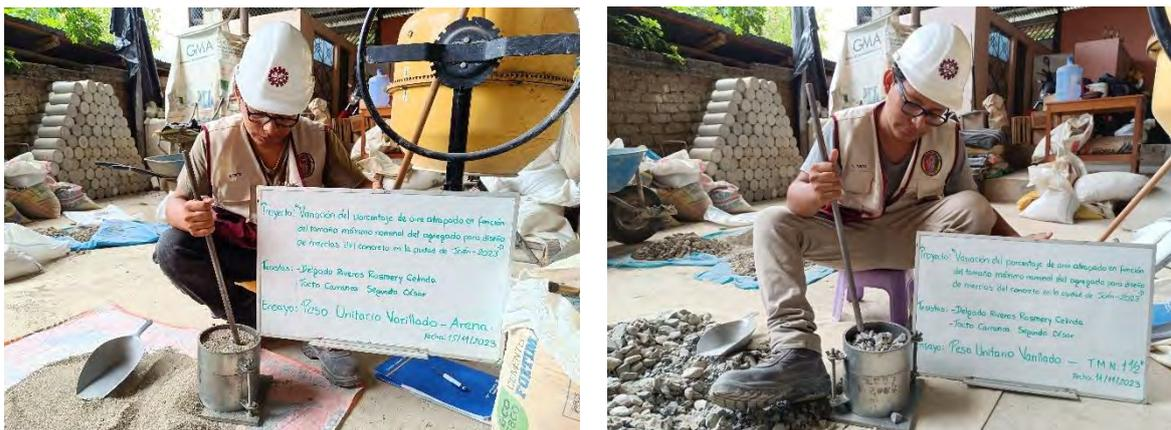
*Nota.* La figura muestra el proceso de varillado de los agregados para determinar el peso unitario compactado. Fuente: 400.017.
