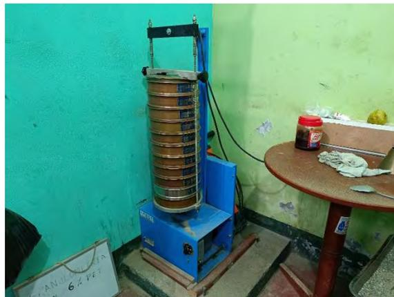
*Nota.* La figura muestra el tamizado del agregado grueso por cada T.M.N. Fuente: Normativa NTP 400.012.
