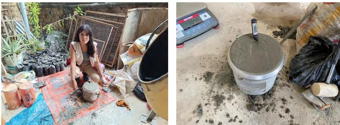
*Nota.* La figura muestra la medición de la temperatura del concreto. Fuente: Normativa NTP 339.184.
