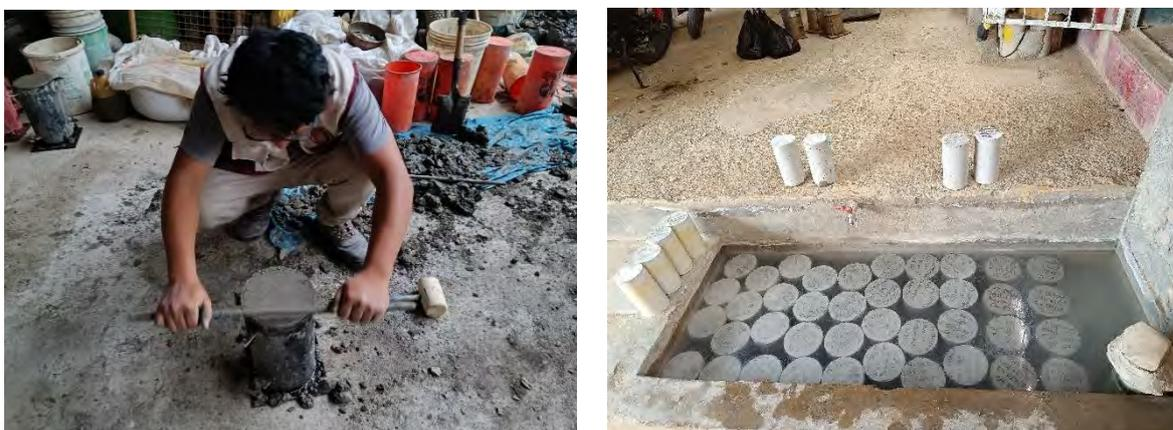
*Nota.* La figura muestra el proceso de elaboración y curado de los especímenes de concreto. Fuente: Normativa NTP 339.183.
