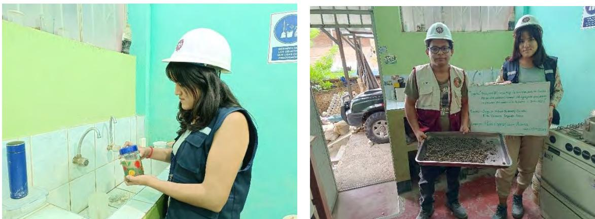
*Nota.* La figura muestra el proceso de decantar el agua y secado del agregado fino. Fuente: Normativa NTP 400.022.
