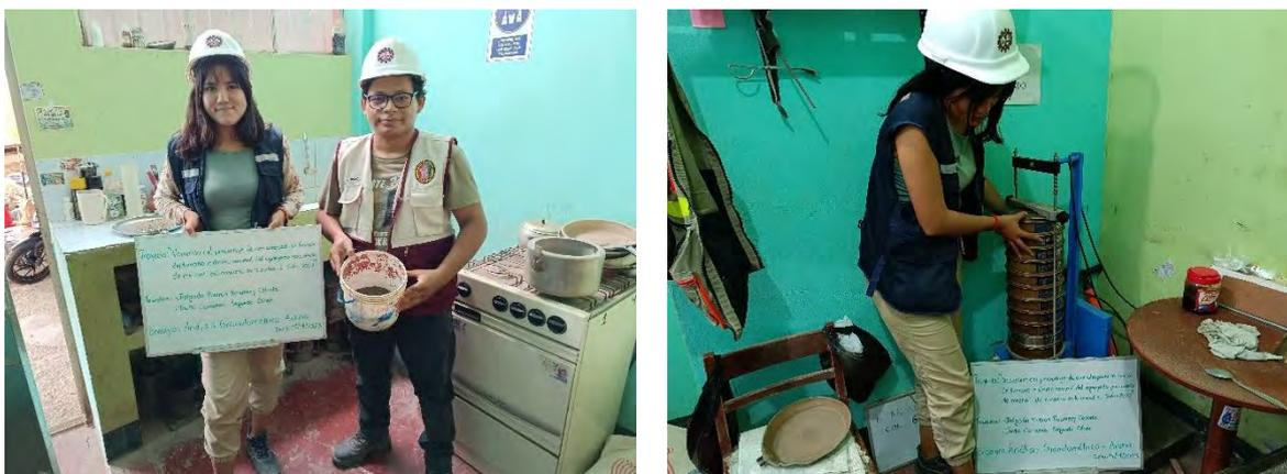
*Nota.* La figura muestra el tamizado del agregado fino. Fuente: Normativa NTP 400.012.
