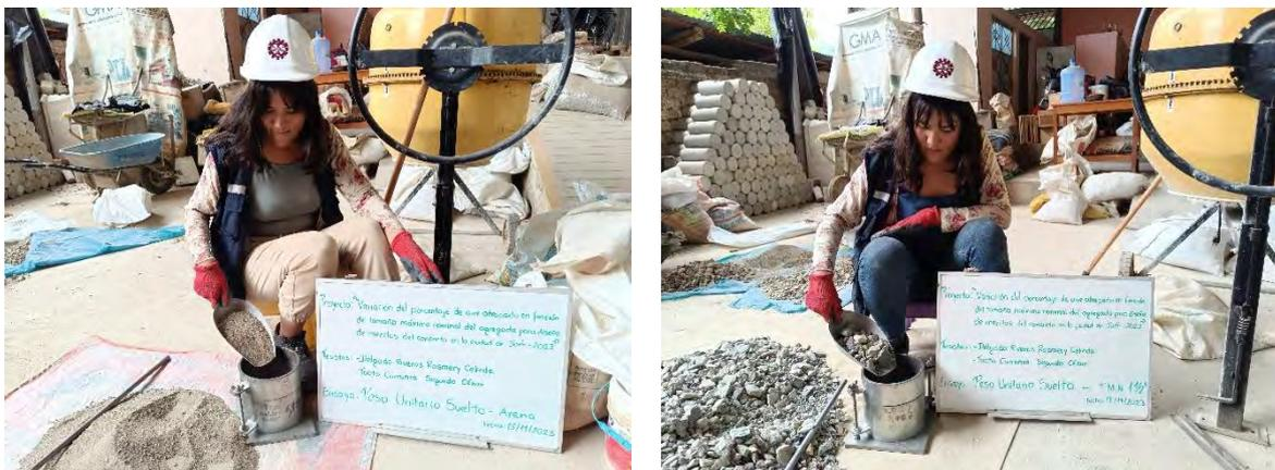
*Nota.* La figura muestra el proceso de vaciado de los agregados al recipiente. Fuente: Normativa NTP 400.017.
