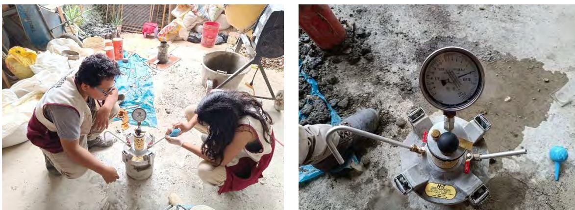
*Nota.* La figura muestra la medición del aire atrapado del concreto. Fuente: Normativa NTP 339.083.
