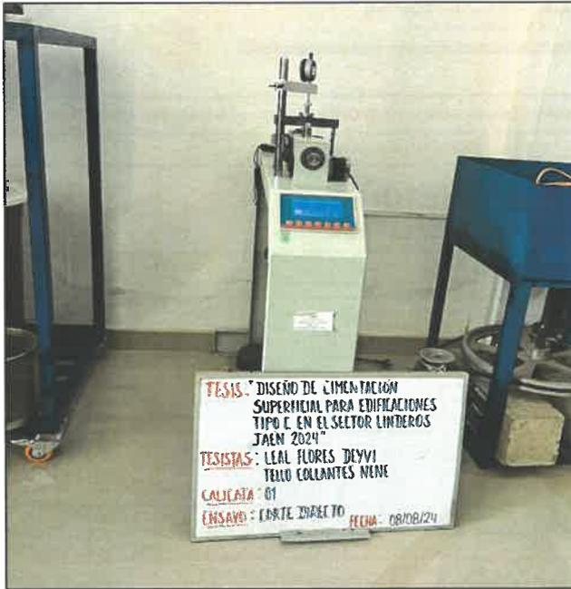
Fig. 20: Ensayo corte directo de calicata 1
