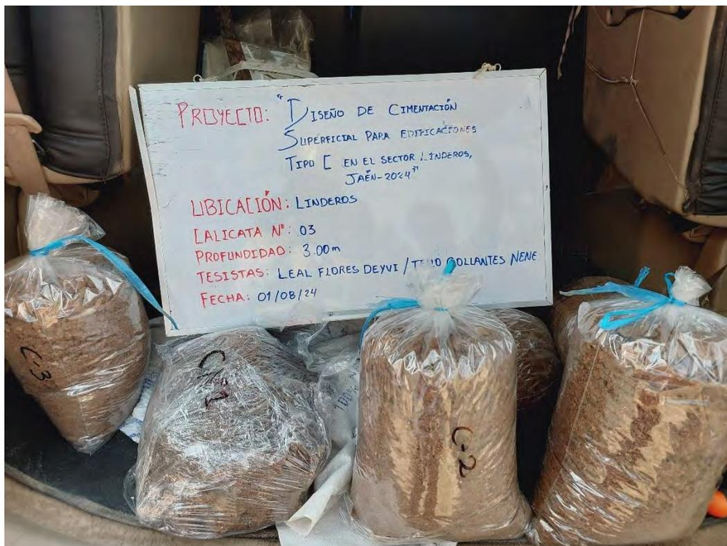
Nota: Se observa la obtención de muestras alteradas e inalteradas en bolsas herméticas para su respectivo traslado.
