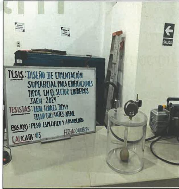
Fig. 19: Ensayo peso específico de calicata 3
