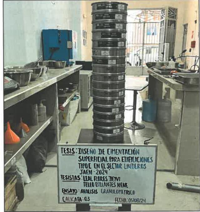
Fig. 13: Ensayo de análisis granulométrico de calicata 3
