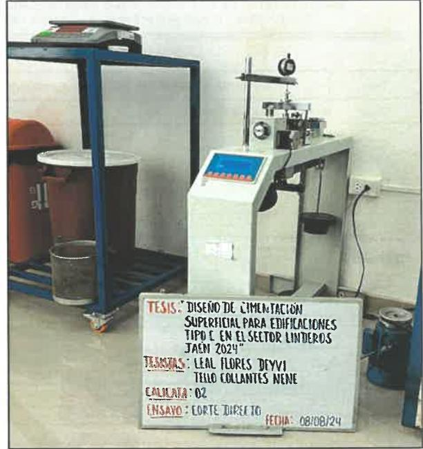
Fig. 21: Ensayo corte directo de calicata 2
