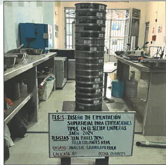
Fig. 11: Ensayo de análisis granulométrico de calicata 1
