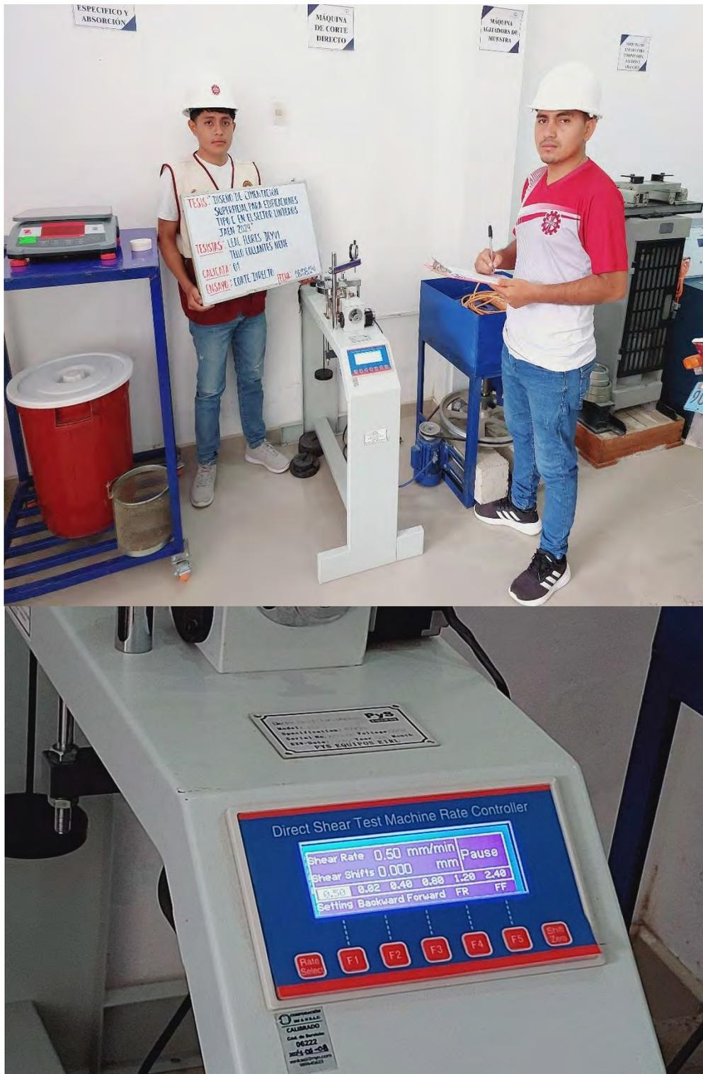
*Nota:* Se observa el desarrollo del ensayo de corte directo utilizando una máquina calibrada, asegurando precisión y confiabilidad en los resultados obtenidos.
