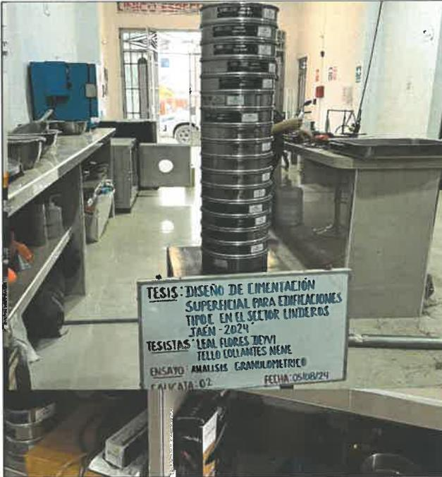
Fig. 12: Ensayo de análisis granulométrico de calicata 2
