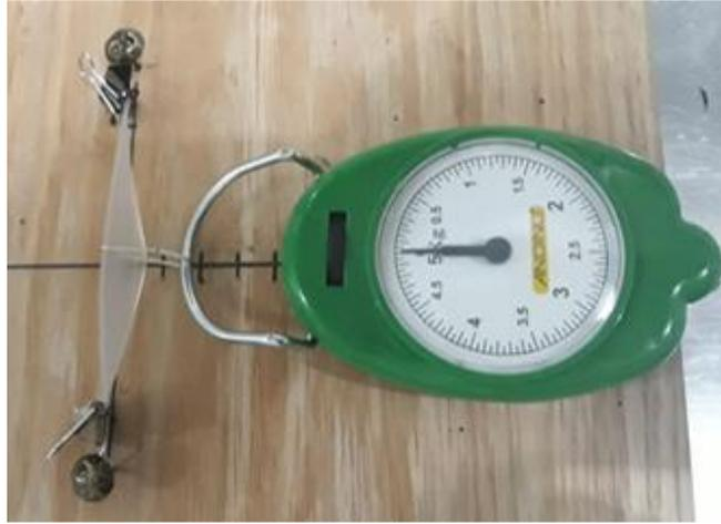
Dispositivo para determinar la longitud de flexión
