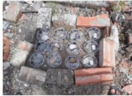
Colocación de muestras de bioplástico
