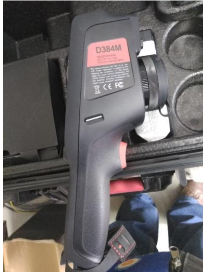
Figura 6. Cámara de Termografía
