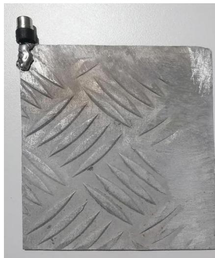
b) Soldadura de los conectores hembras en el electrodo
