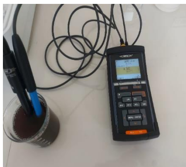
d. Lectura del pH, Conductividad eléctrica
