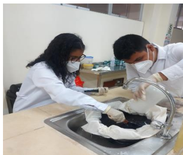
c. Lavado del carbón activado de Cocos nucifera
