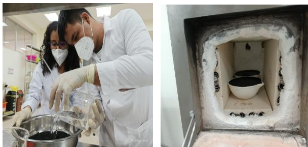
b. Activación del carbón de Cocos nucifera
