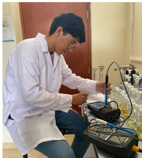
Figura 11. Lectura del pH y C.E del suelo
