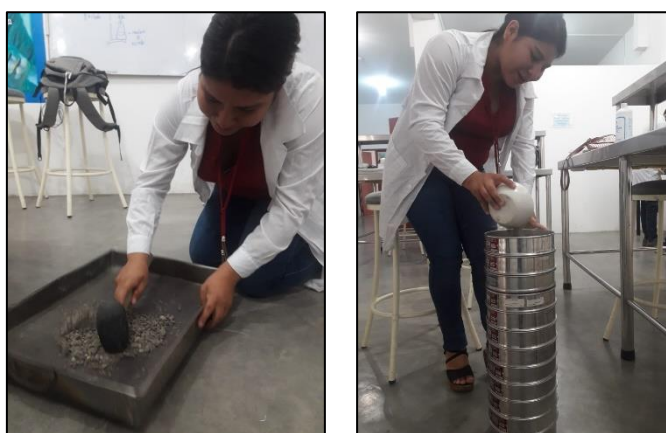
Fig. 4. Acondicionamiento del suelo
