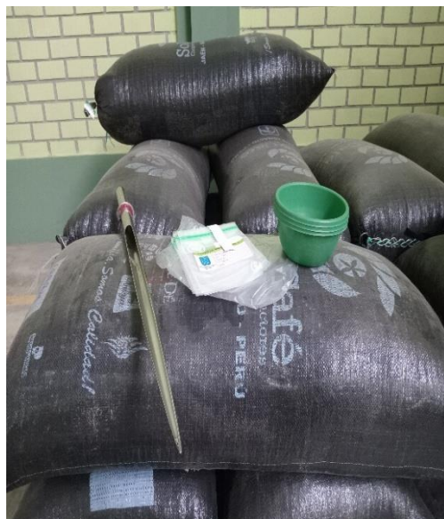
Figura 4: Materiales para la extracción de muestras
