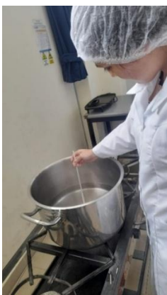
Inactivación de enzimas de la cáscara mediante escaldado
