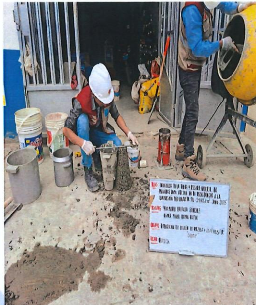
FIG. N° 14: ENSAYO DE SLUMP + 2.5% F + 10.5% R
