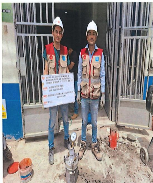
FIG. N° 21: ENSAYO DE CONTENIDO DE AIRE + 6.5% F +10.5% R
