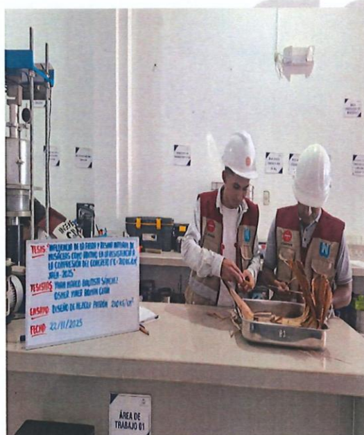
FIG. N° 07: PREPARACIÓN DE MUESTRA ADICIÓN PARA DISEÑO DE MEZCLA 210 KG/CM2
