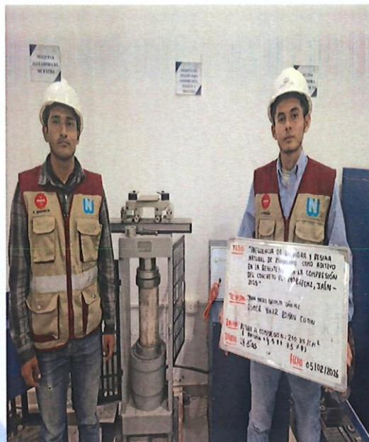
FIG. N° 34: ENSAYO DE ROTURA A COMPRESIÓN 210 KG/CM 2 + 4.5% F + 7.5 % R A LOS 28 DIAS
