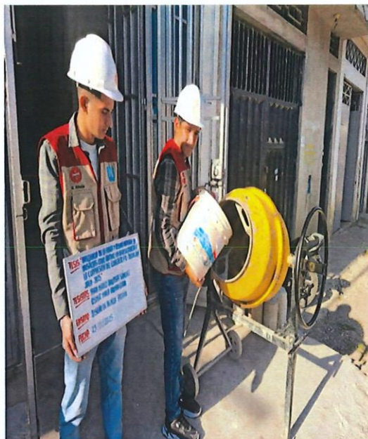
FIG. N° 09: DISEÑO DE MEZCLA 210 KG/CM2, PATRÓN
