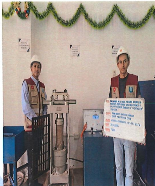
FIG. N° 30: ENSAYO DE ROTURA A COMPRESIÓN 210 KG/CM 2 + 2.5% F + 4.5% R A LOS 7 DIAS
