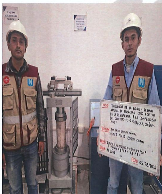
FIG. N° 35: ENSAYO DE ROTURA A COMPRESIÓN 210 KG/CM 2 + 6.5% F + 7.5 % R A LOS 14 DIAS
