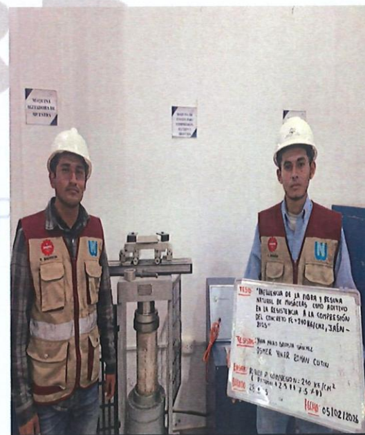
FIG. N° 32: ENSAYO DE ROTURA A COMPRESIÓN 210 KG/CM 2 + 2.5% F + 7.5 % R A LOS 28 DIAS
