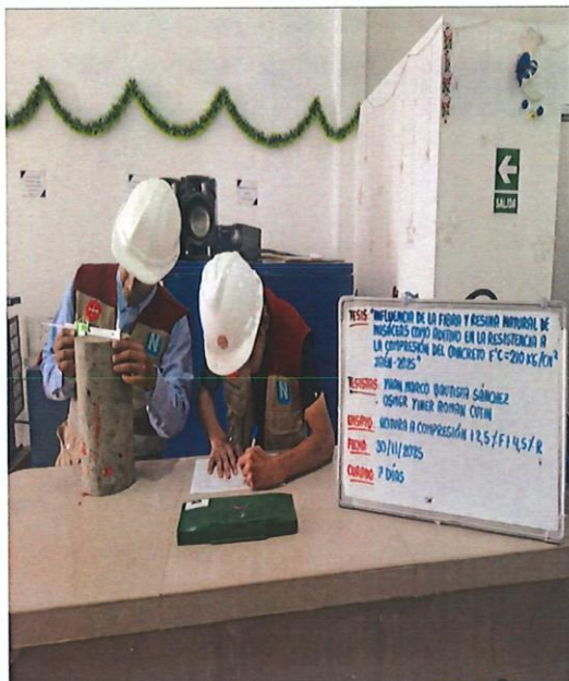
FIG. N° 29: TOMA DE MEDIDAS DE PROBETAS + 2.5% F + 4.5% R A LOS 7 DIAS
