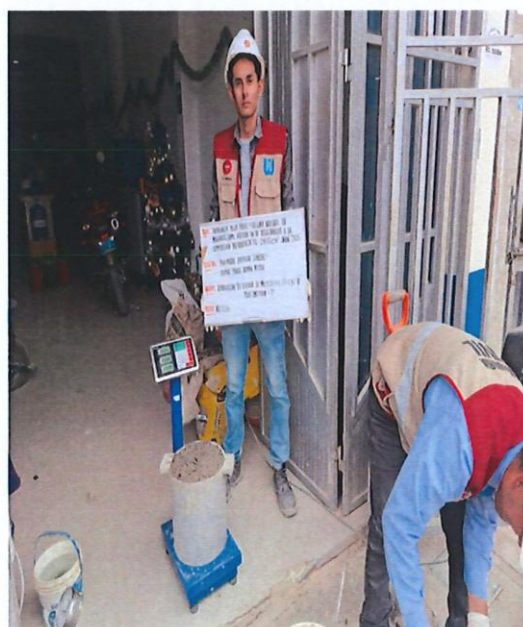
FIG. N° 11: ENSAYO DE PESO UNITARIO DEL CONCRETO + 4.5% F + 7.5% R
