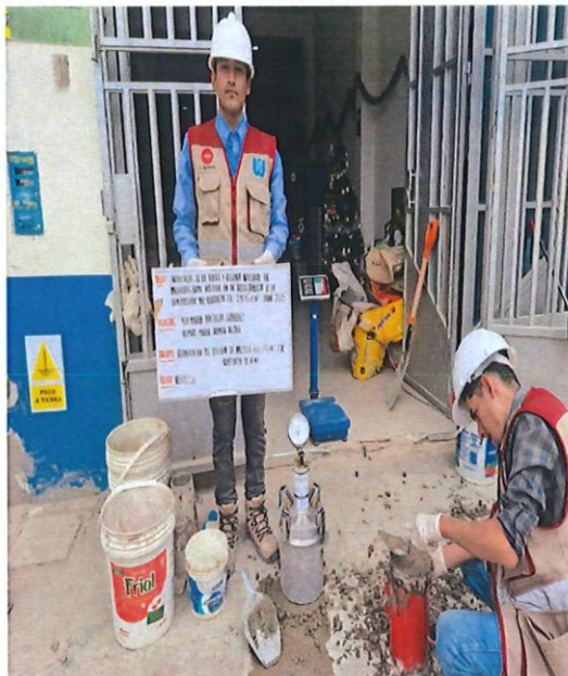
FIG. N° 13: ENSAYO DE CONTENIDO DE AIRE + 4.5% F + 4.5% R
