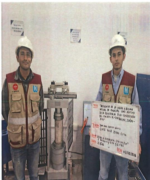
FIG. N° 33: ENSAYO DE ROTURA A COMPRESIÓN 210 KG/CM 2 + 4.5% F + 4.5 % R A LOS 28 DIAS
