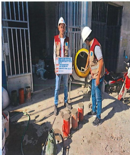
FIG. N° 18: LLENADO DE PROBETAS PATRÓN 210 KG/CM2
