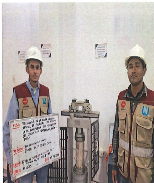
FIG. N° 37: ENSAYO DE ROTURA A COMPRESIÓN 210 KG/CM 2 + 6.5% F + 10.5 % R A LOS 14 DIAS
