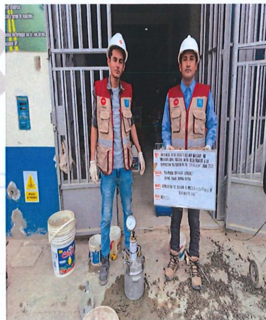
FIG. N° 16: ENSAYO DE CONTENIDO DE AIRE + 2.5% F + 10.5% R
