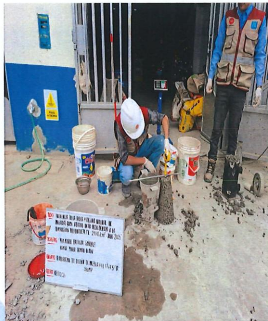
FIG. N° 10: ENSAYO SLUMP + 4.5% F + 7.5% R
