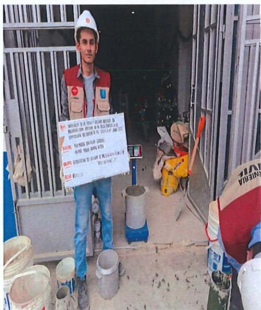
FIG. N° 15: ENSAYO DE PESO UNITARIO DEL CONCRETO + 2.5% F + 10.5% R
