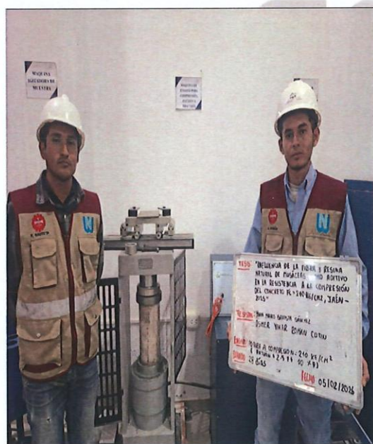
FIG. N° 31: ENSAYO DE ROTURA A COMPRESIÓN 210 KG/CM 2 + 2.5% F + 10.5 % R A LOS 28 DIAS
