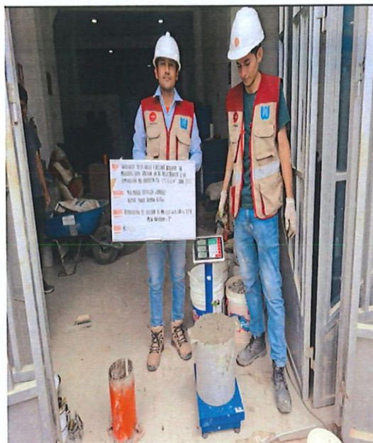
FIG. N° 25: ENSAYO DE PESO UNITARIO DEL CONCRETO + 4.5% F +6.5% R
