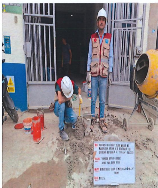
FIG. N° 19: ENSAYO DE SLUMP 210 KG/CM2 + 6.5% F + 10.5 % R
