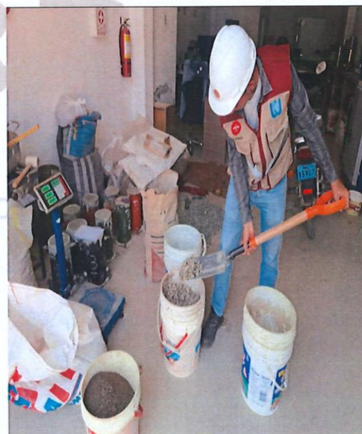
FIG. N° 08: DOSIFICACIÓN DE TANDA PARA DISEÑO DE MEZCLA 210 KG/CM2
