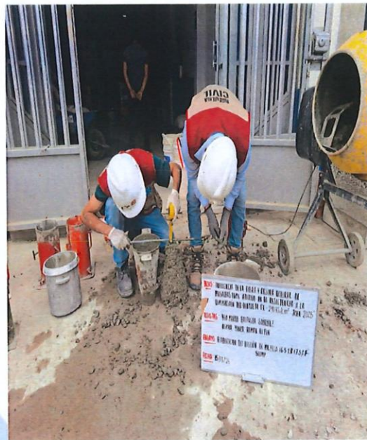
FIG. N° 22: ENSAYO DE SLUMP 210 KG/CM2 + 6.5% F + 7.5 % R
