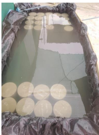
Figura 50. Curado de testigos de concreto de construcción informal 03
