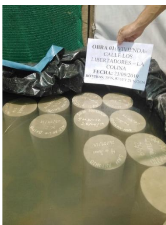
Figura 39. Curado de testigos de concreto de construcción informal 01
