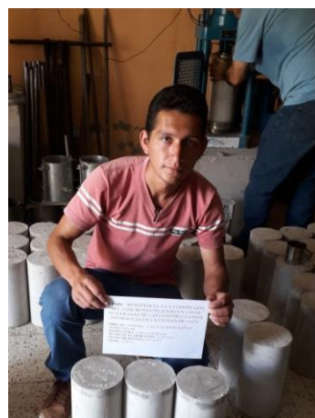
Figura 44. Rotura de testigos de concreto de construcción informal 02
