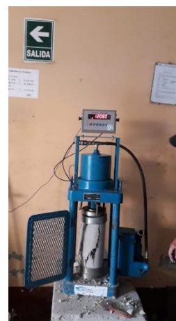
Figura 51. Rotura de testigos de concreto de construcción informal 03
