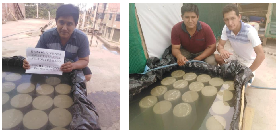
Figura 9. Figura 10. Curado de testigos de concreto.
