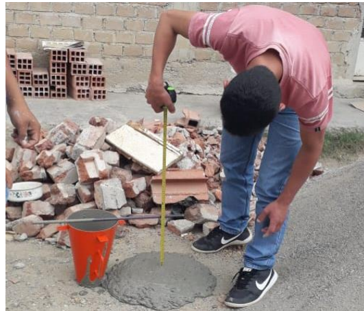
Figura 5. Figura 6. Ensayo para medir el asentamiento del concreto (Slump), utilizando el Cono de Abrams
