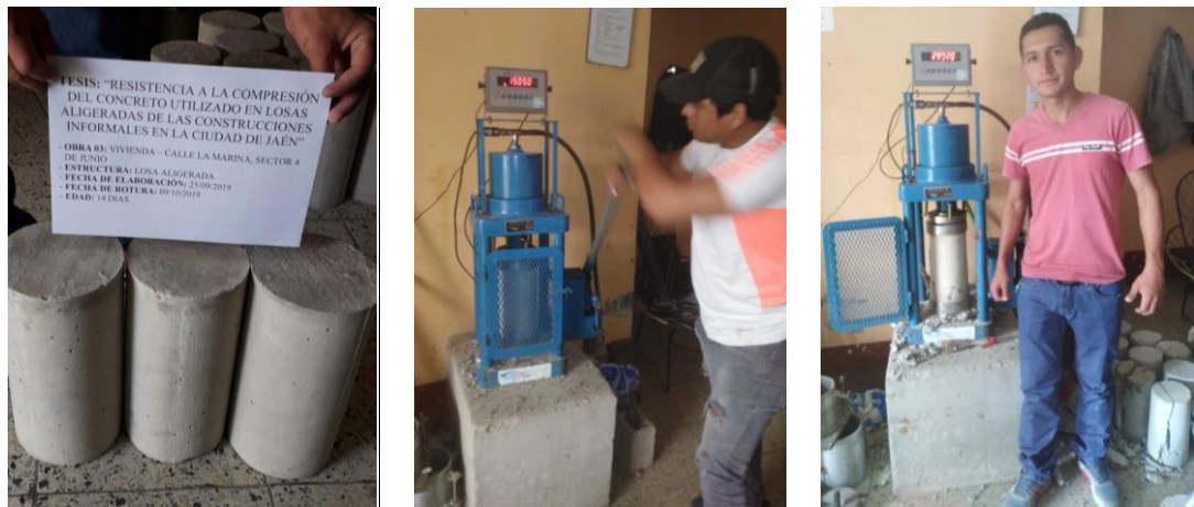
Figura 14. Figura 15. Figura 16. Rotura de testigos de concreto a los 14 días.
