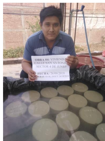
Figura 56. Curado de testigos de concreto de construcción informal 04
