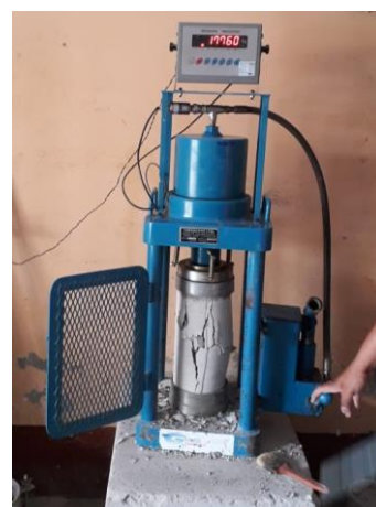
Figura 38. Rotura de testigos de concreto de construcción informal 01
