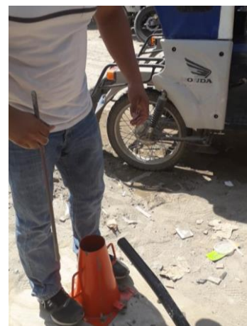
Figura 53. Asentamiento del concreto en construcción informal 04
