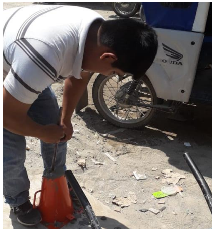
Figura 5. Figura 6. Ensayo para medir el asentamiento del concreto (Slump), utilizando el Cono de Abrams
