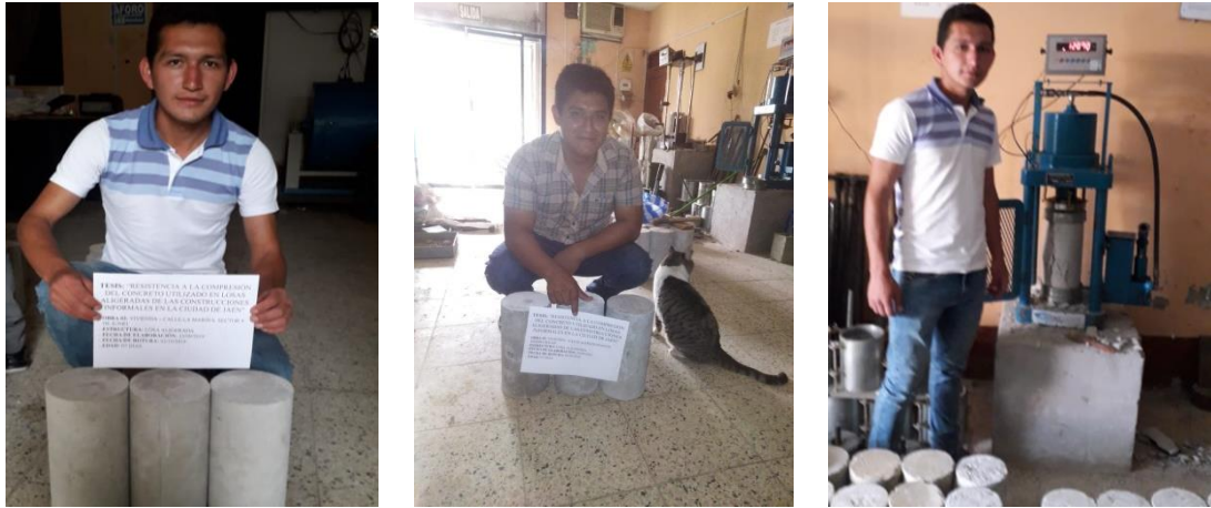
Figura 11. Figura 12. Figura 13. Rotura de testigos de concreto a los 7 días
