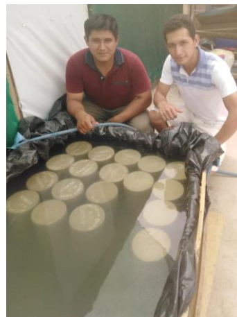
Figura 63. Curado de testigos de concreto de construcción informal 05
