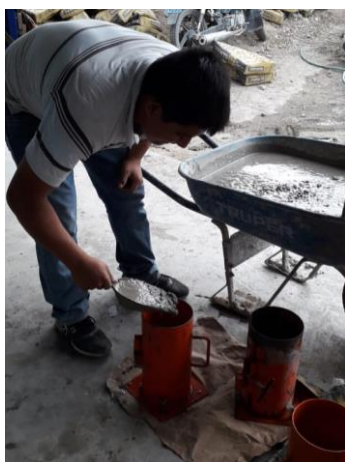
Figura 49. Elaboración de testigos de concreto en construcción informal 03
