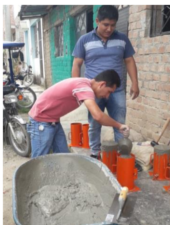
Figura 37. Elaboración de testigos de concreto en construcción informal 01
