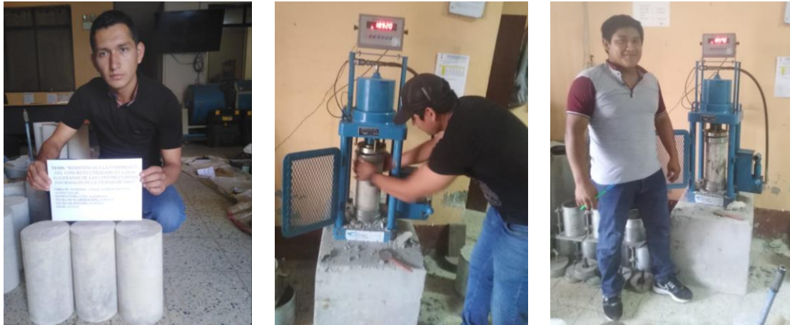
Figura 17. Figura 18. Figura 19. Rotura de testigos de concreto a los 28 días.
