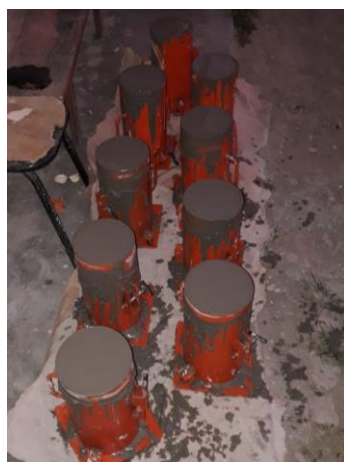
Figura 55. Elaboración de testigos de concreto en construcción informal 04
