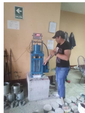
Figura 57. Rotura de testigos de concreto de construcción informal 04
