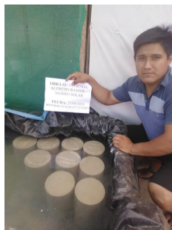
Figura 45. Curado de testigos de concreto de construcción informal 02
