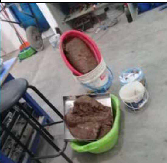
Figura 18. Decantación de los adobes saturados para la eliminación del agua superficial excedente.
