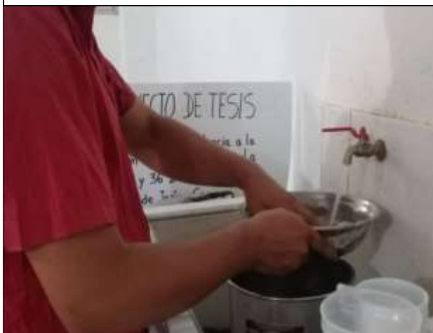
Figura 5. Realizando ensayo de granulometría por el método de lavado.
