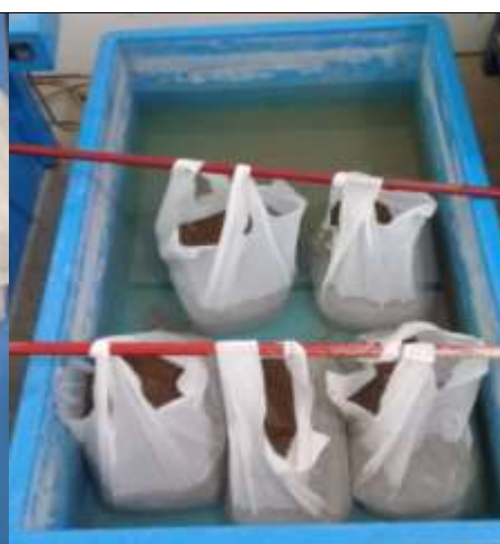
Figura 29. Adobes en bolsas plásticas enrasadas con agua y sumergidas en un tanque con agua.
