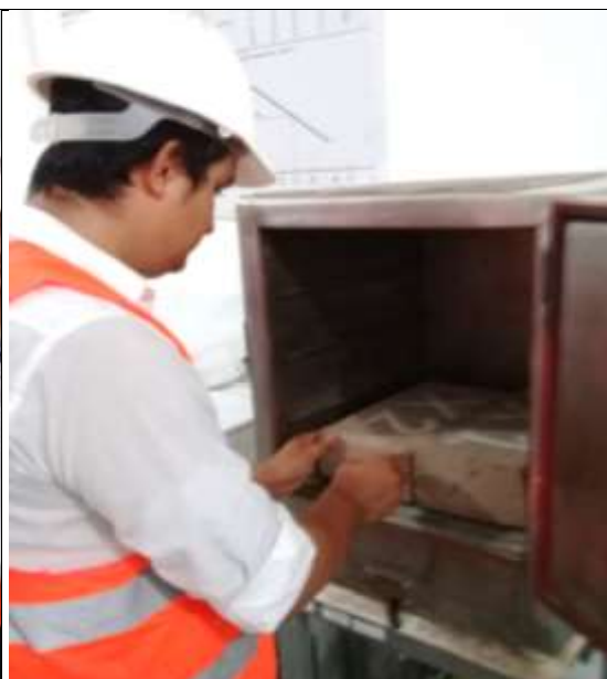
Figura 16. Adobes secados en el horno por 24 horas.
