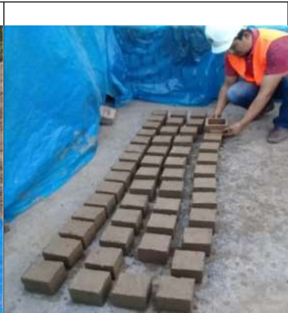
Figura 8. Elaboración de adobes para la resistencia a la compresión.
