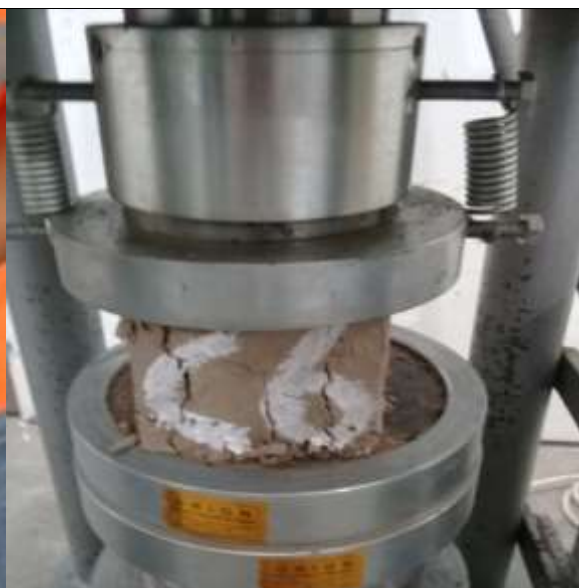
Figura 12. Probeta de adobe fracturada en el ensayo de resistencia a la compresión
