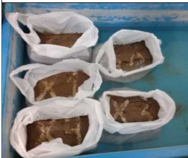
Figura 17. Probetas de adobe saturadas después de sumergidas 24 horas en agua.
