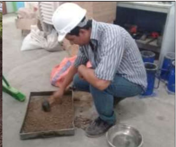
Figura 2. Trituración de la muestra para obtener material más homogéneo.
