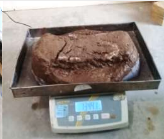
Figura 31. Pesado de los adobes saturados para determinar su absorción.
