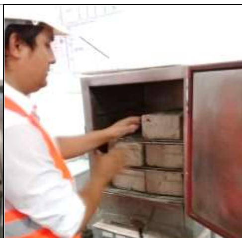
Figura 27. Secado de los adobes en el horno por 24 horas.
