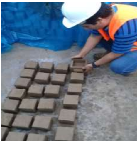
Figura 18. Elaboración de los adobes para resistencia a la compresión.
