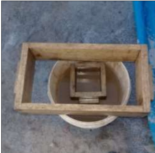
Figura 16. Humedecimiento de los moldes para facilitar el desprendimiento de la mezcla.
