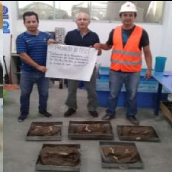
Figura 20. Ensayo de absorción de humedad en el laboratorio de mecánica de suelos de la Facultad de Ingeniería Civil - UNJ.
