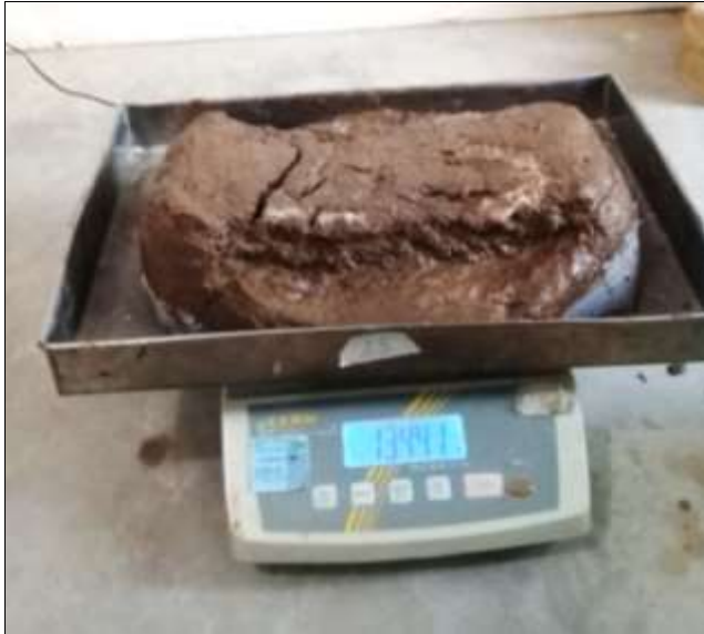
Figura 19. Pesado de los adobes saturados para determinar su absorción.
