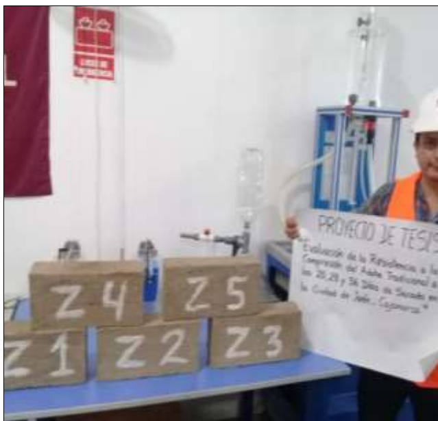
Figura 15. Especímenes rotulados para ser ensayados a absorción.
