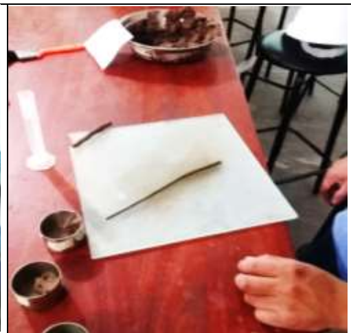
Figura 8. Realizando el Límite Plástico.
