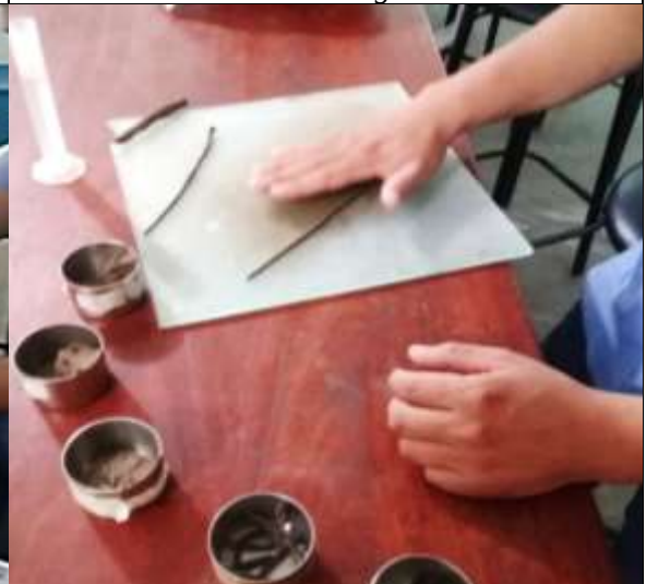
Figura 4. Realizando el Límite Plástico.
