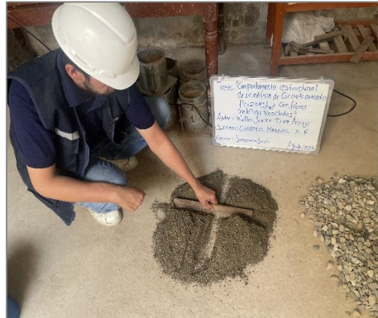
Figura 4. Cuarteo de la muestra
