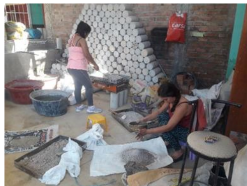
Figura 18. Pasamos el material por la malla N° 04
