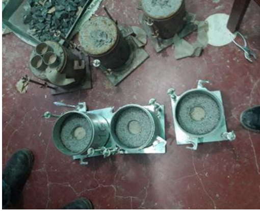
Figura 32. Desmontaje de los moldes
