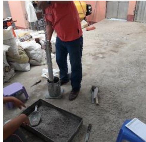
Figura 27. Compactación de los especímenes
