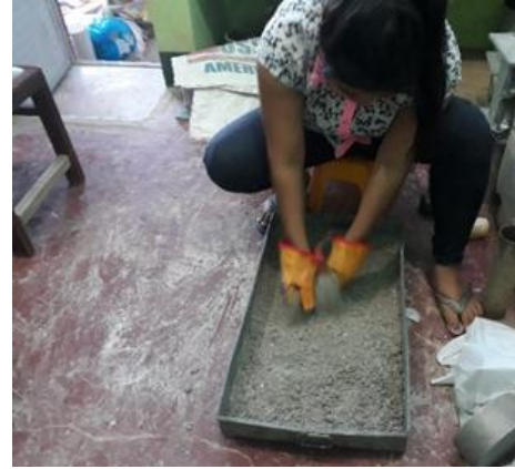
Figura 20. Mezclado de material con el agua
