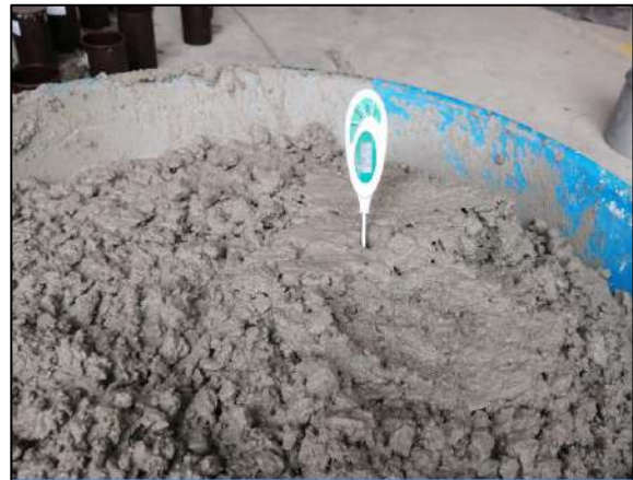
Imagen 37. Control de la temperatura
