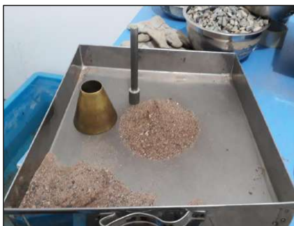
Imagen 12. Prueba del cono para determinar la humedad superficial
