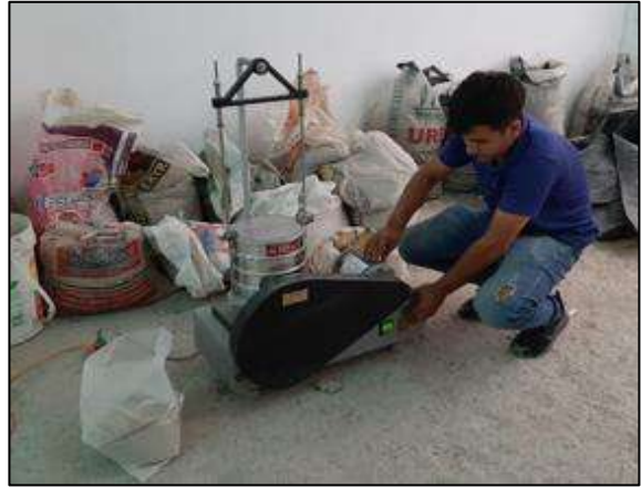
Imagen 29. Tamizado en maquina tamizadora para aumentar la eficiencia
