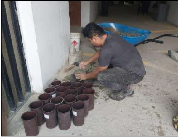
Imagen 42. Llenado de testigos cilíndricos
