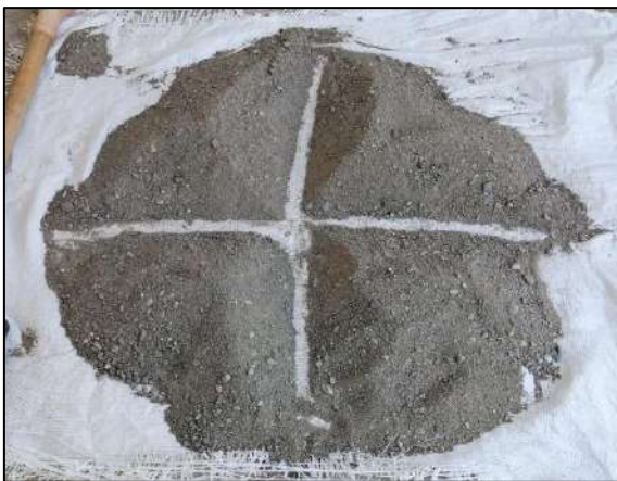
Imagen 2. Cuarteo del agregado
