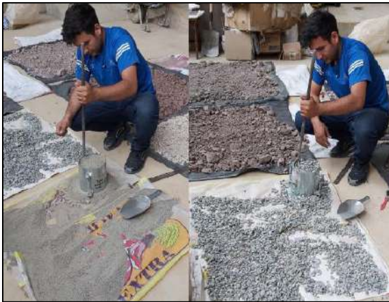
Imagen 26. Llenado por compactado del molde con agregado
