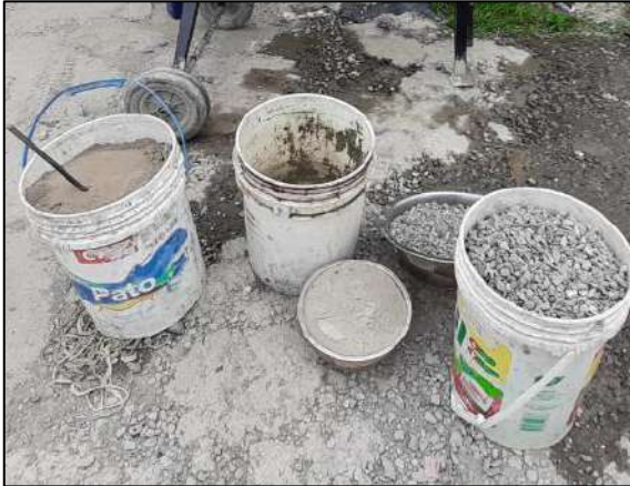
Imagen 32. Cantidad de materiales por tanda de preparación
