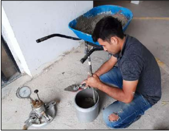
Imagen 40. Llenado de la olla por medio de varillado
