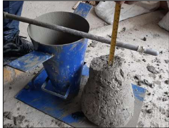
Imagen 35. Medida del asentamiento o Slump
