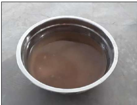
Imagen 10. Agregado fino sumergido en el agua
