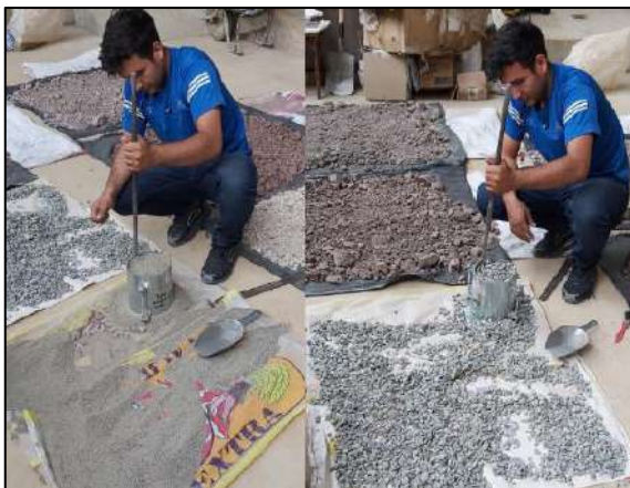
Imagen 24. Llenado del molde con agregado
