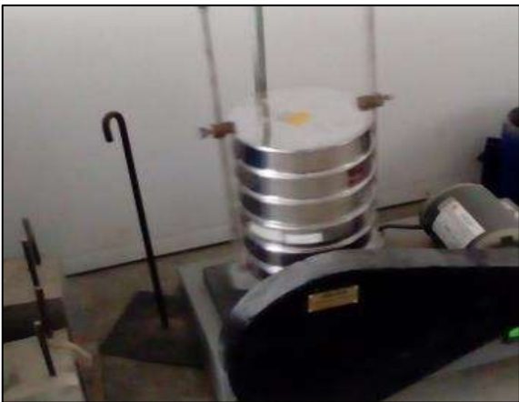
Imagen 8. Tamizado mecánico de agregados
