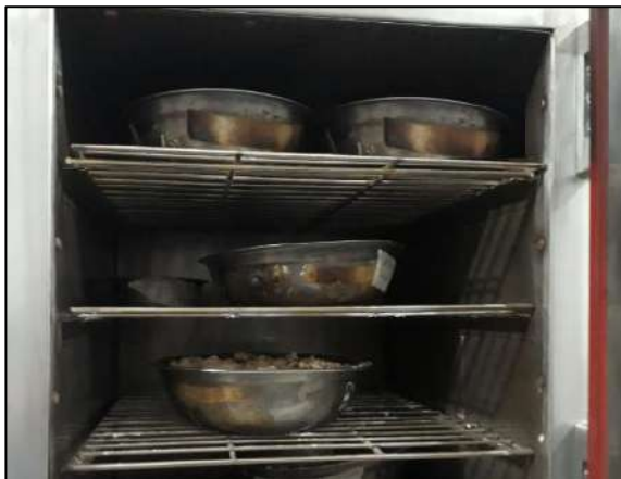
Imagen 22. Secado de la muestra en el horno
