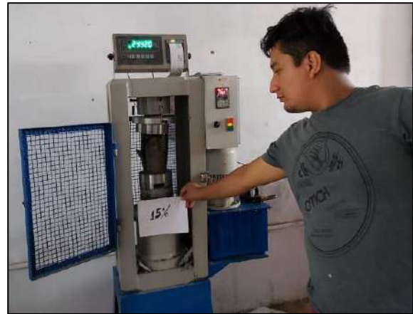
Imagen 49. Ensayo de rotura de testigos cilíndricos
