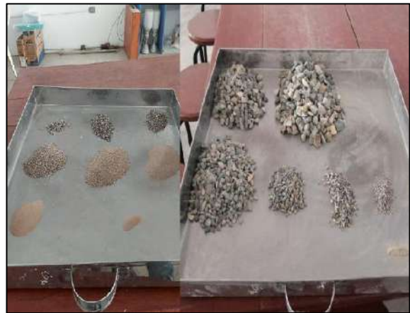
Imagen 9. Muestras tamizadas y pesadas
