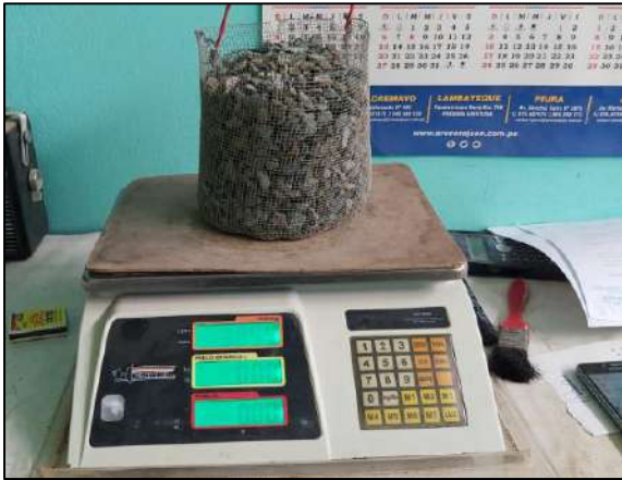
Imagen 20. Pesado de la muestra saturada con superficie seca (SSS)
