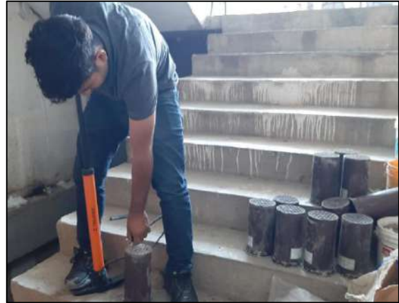
Imagen 45. Desmoldado de testigos
