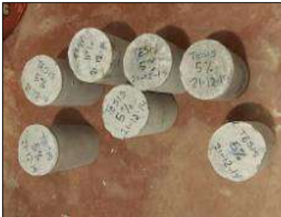
Imagen 48. Testigos con periodo para ser ensayados a compresión
