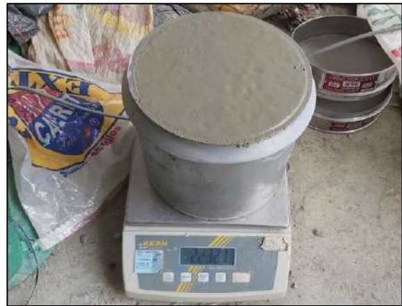
Imagen 39. Masa del molde con concreto
