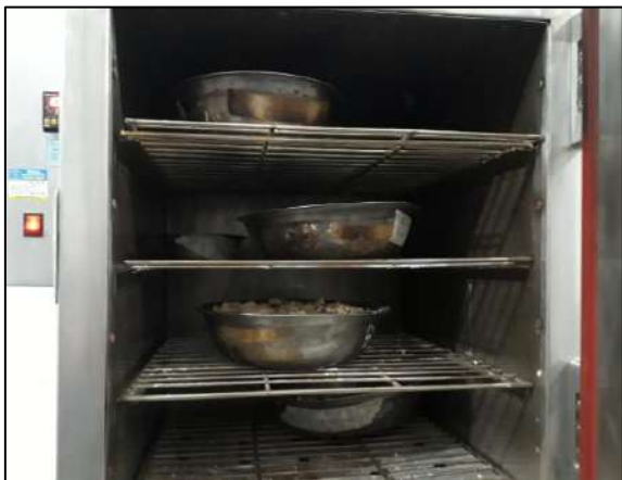
Imagen 4. Secado de la muestra de agregados en el horno
