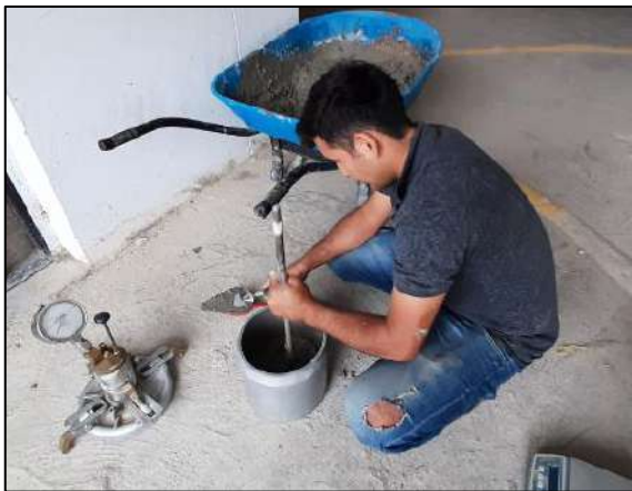
Imagen 38 . Llenado y varillado del molde
