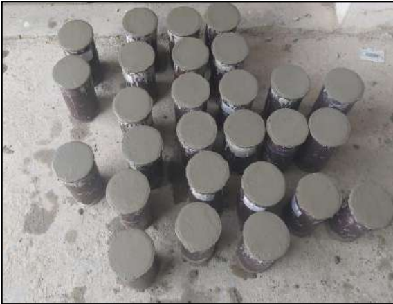
Imagen 44. Testigos en proceso de secado
