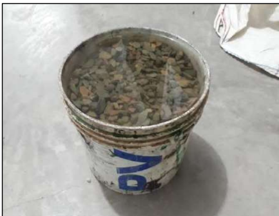
Imagen 18 . Agregado grueso sumergido en agua por 24 horas
