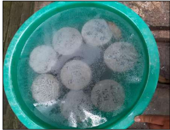
Imagen 47. Curado de testigos cilíndricos
