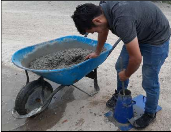
Imagen 34. Llenado del cono de Abrams por medio de varillado
