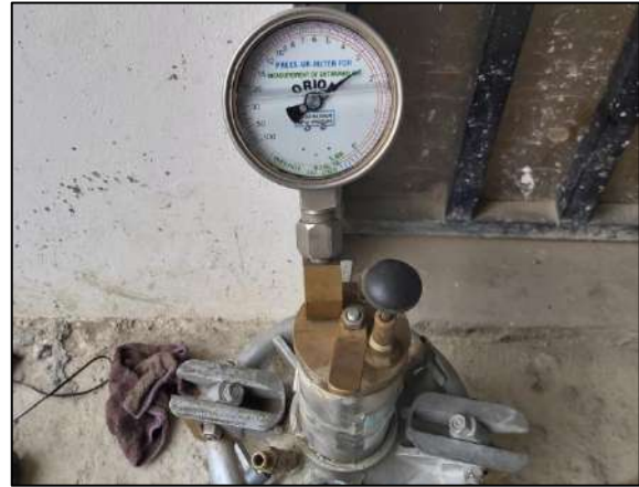
Imagen 41. Medida del contenido de aire
