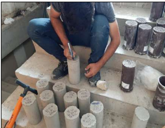
Imagen 46. Colocado de código a los testigos
