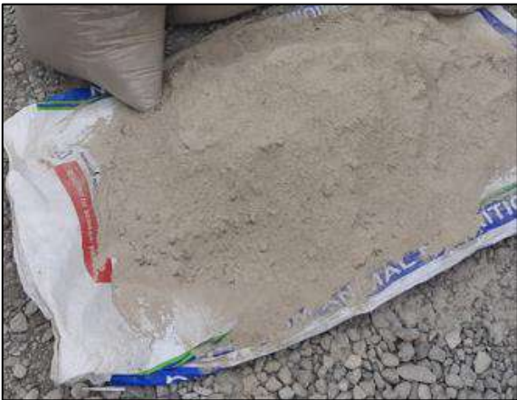
Imagen 30. Material fino después de ser tamizado en el tamiz N° 200
