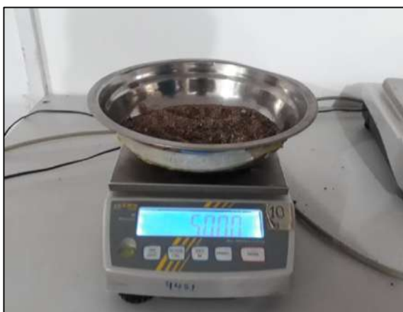
Imagen 13. Pesado de la muestra saturada con superficie seca (SSS)
