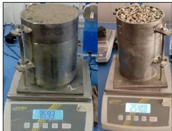
Imagen 25. Peso del molde con agregado suelto
