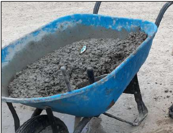
Imagen 36. Colocación del termómetro
