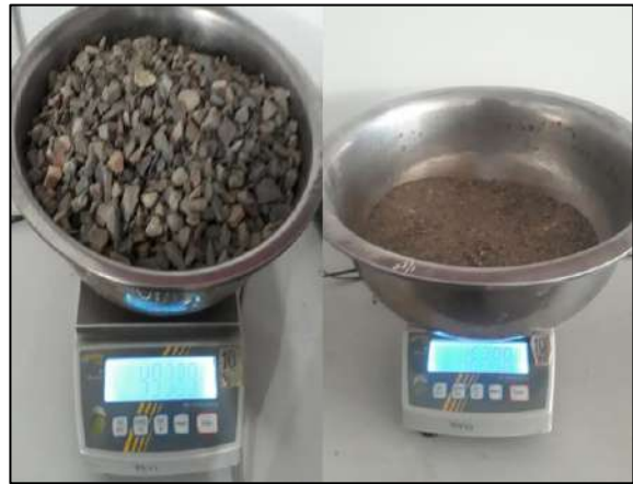
Imagen 5. Pesado de la muestra después de ser secada
