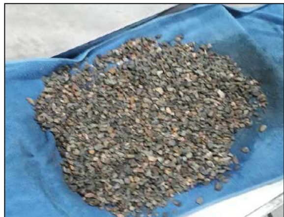
Imagen 19. Eliminación de la película de agua visible
