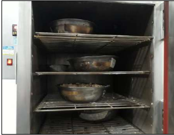
Imagen 16. Secado de la muestra de agregado en el horno
