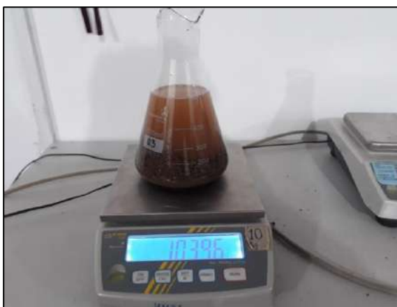
Imagen 15. Peso del picnómetro más 500 gr de muestra (SSS)
