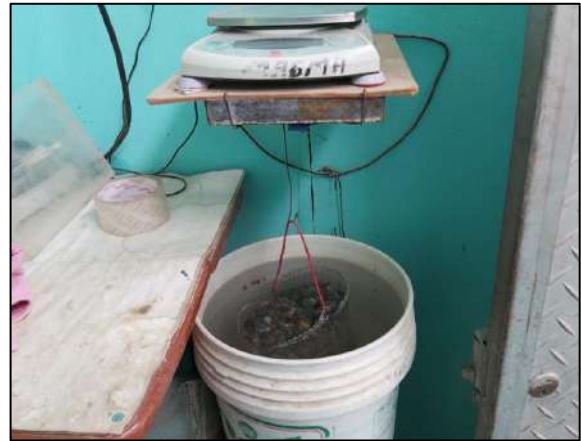
Imagen 21. Determinación del peso de la muestra sumergido en agua
