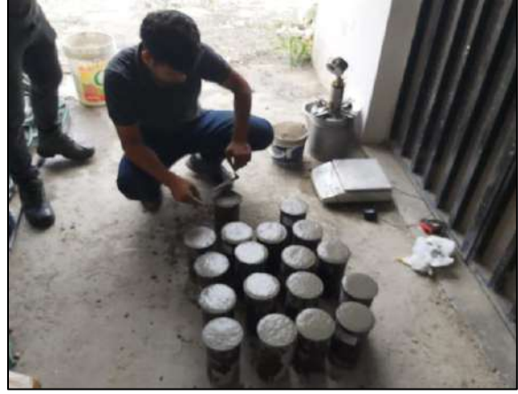
Imagen 43. Enrazado de testigos cilíndricos
