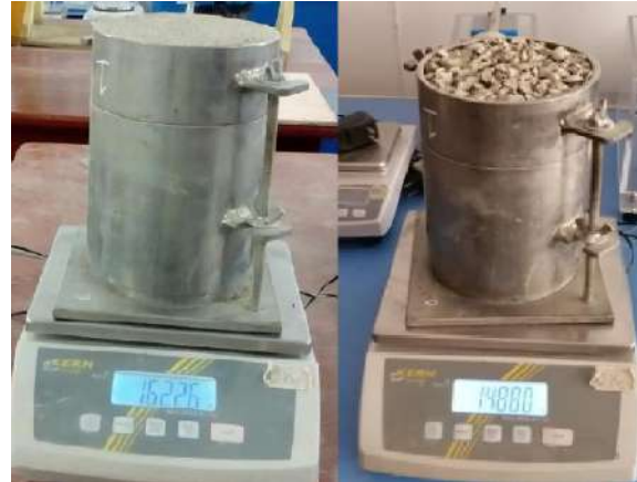
Imagen 27. Peso del recipiente con agregado compactado
