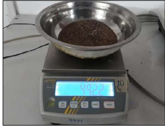
Imagen 17. Peso en el aire de la muestra secada en horno
