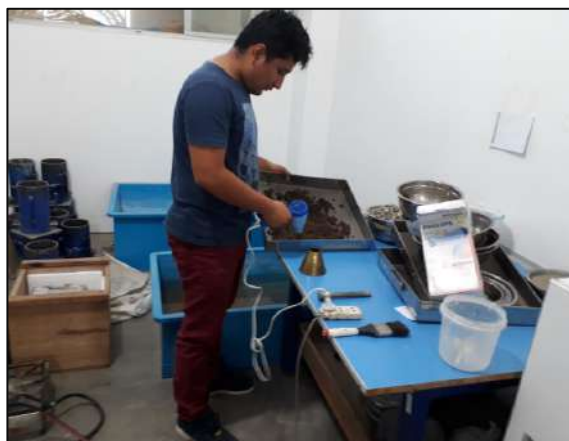
Imagen 11. Secado del agregado fino por medio de secadora
