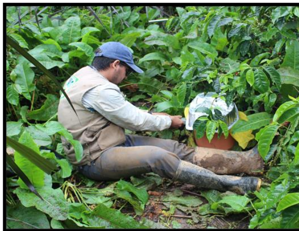
Fotografía 1,2 y 3. Proceso de toma de muestra de gas procedenete de la cámara dinámica cerrada.
