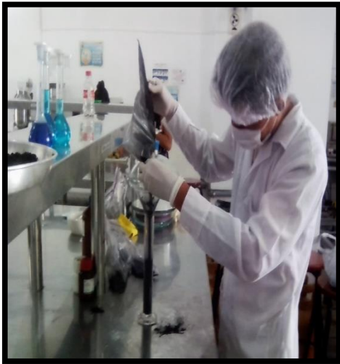
Figura 19. Midiendo el volumen del carbón activado para determinar la densidad.
