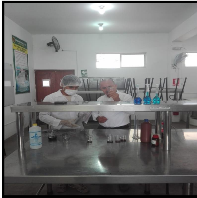
Figura 24. Observando la decoloración del azul de metileno de las muestras de carbón activado.
