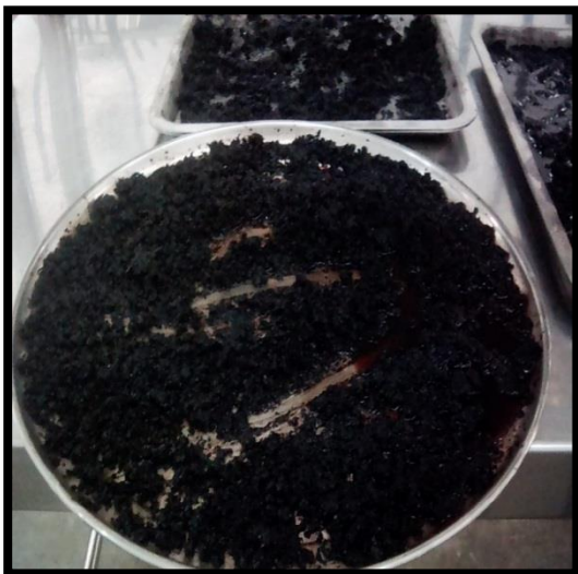
Figura 9. Impregnación de la testa de almendra de cacao con ácido fosfórico a 60% de concentración.
