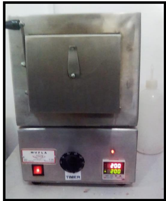
Figura 13. Carbonización a 200 °C.
