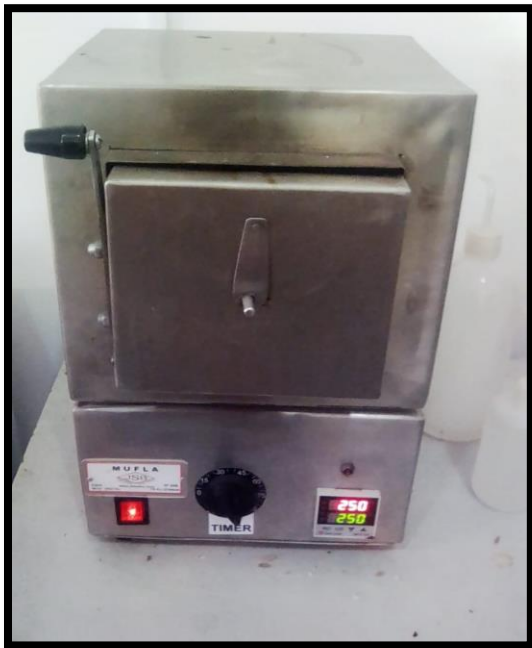
Figura 12. Carbonización a 250 °C.
