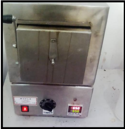
Figura 21. Incineración a 950 °C para determinar la materia volátil
