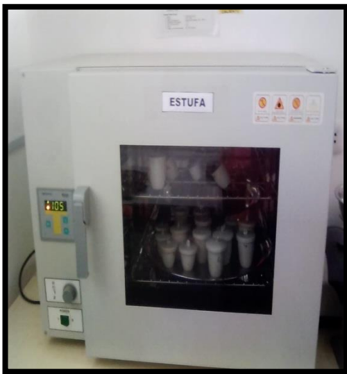
Figura 23. Deshidratación a 105 °C para determinar la humedad.
