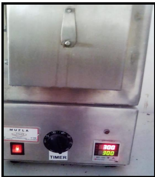
Figura 11. Carbonización a 300°C.
