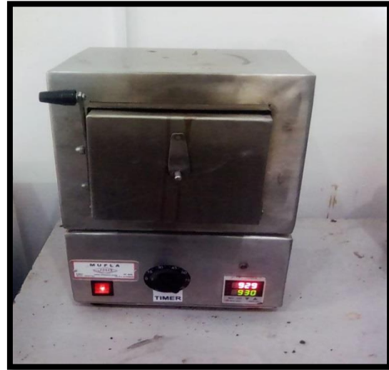
Figura 20. Incineración a 650 °C para determinar cenizas.
