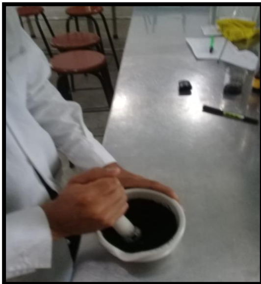
Figura 15. Disminución de la granulometría del carbón activado
