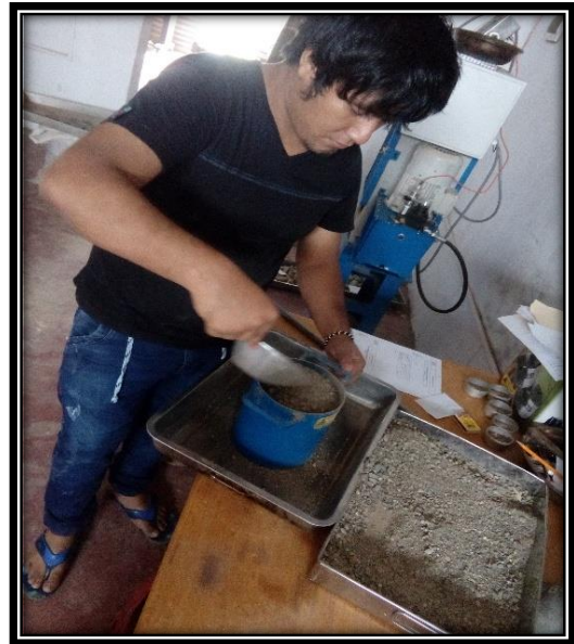
Foto N° 17: Realizando el procedimiento para el ensayo de P.U.S de agregado fino
