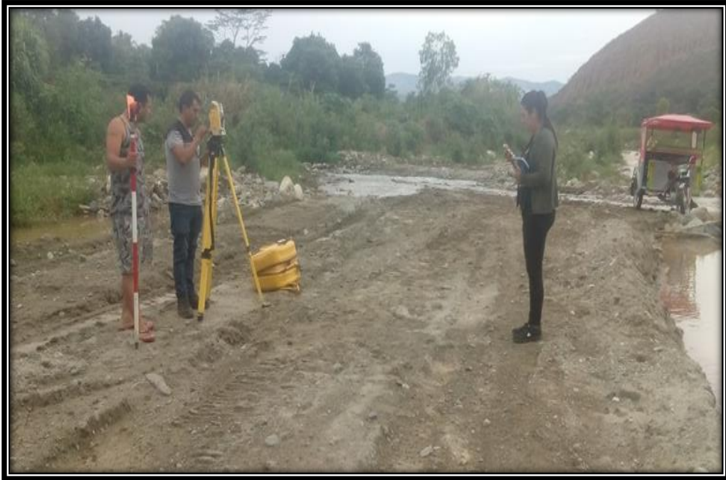
Foto N° 03: Trabajo en campo de topografía con estación total en cantera Santa Rosa Fuente: Elaboración propia
