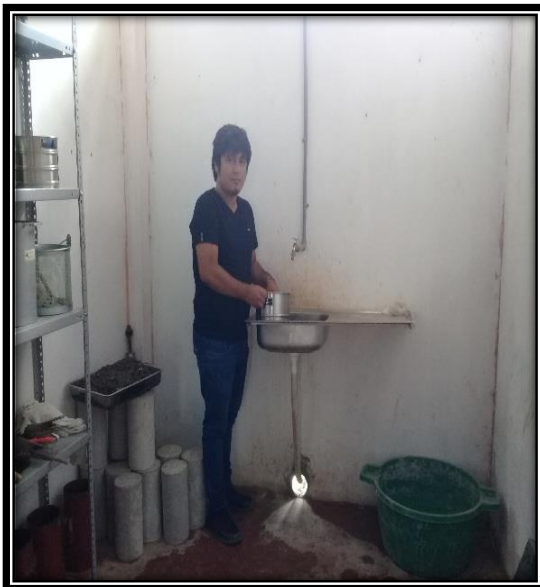
Foto N° 18: Lavado del material retenido en el tamiz
