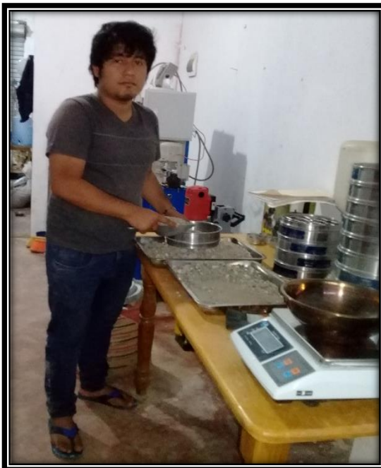
Foto N° 21: realizando el ensayo granulométrico de los agregados
