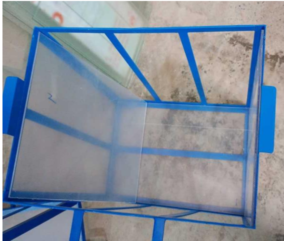
Base de tanque con acrílico acondicionado
