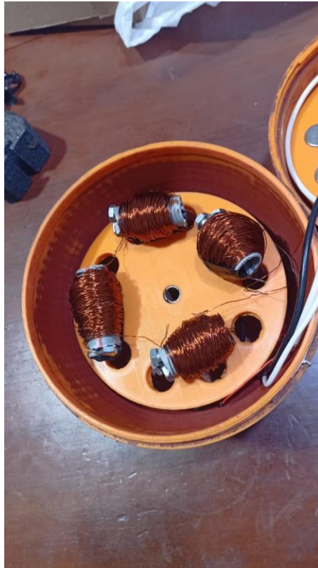
Anexo 17. Armado interno de la boya parte inferior.
