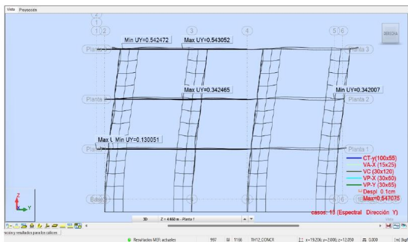
Figura 30. Desplazamiento de la edificación generado por la fuerza sísmica en el sentido Y-Y
