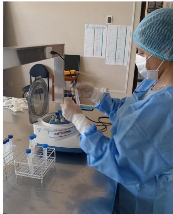
Figura 17. Centrifugación de las muestras de aguas para el análisis parasitológico
