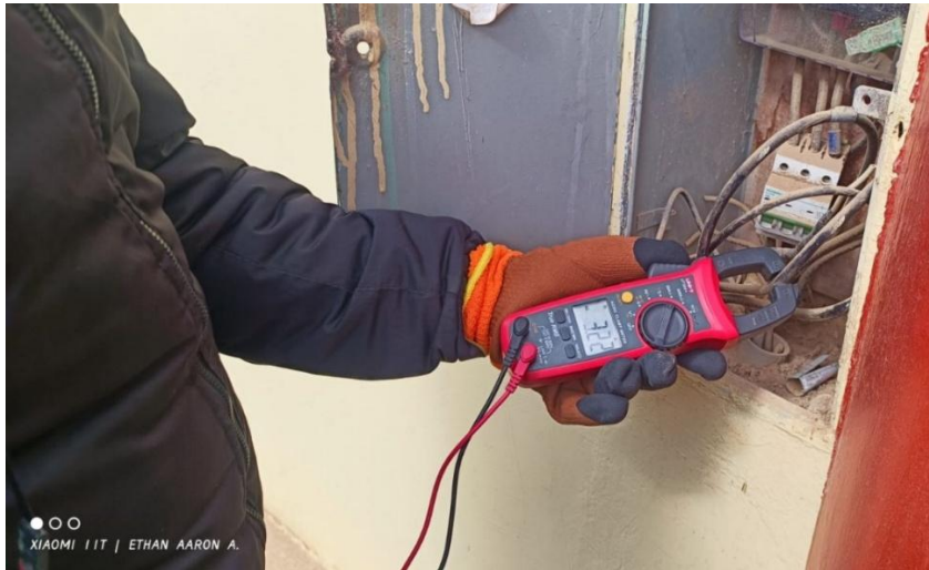
Figura 5 Medición de corriente con pinza amperimétrica
