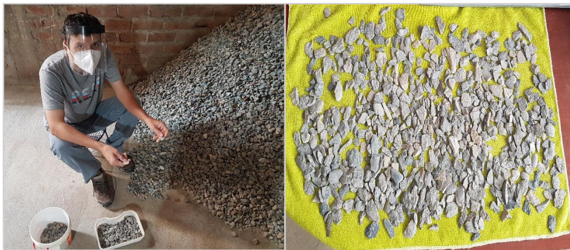
Selección de Partículas Chatas y Alargadas del Agregado Grueso
