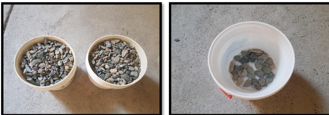
AGREGADO GRUESO Y PARTÍCULAS CHATAS Y ALARGADAS
