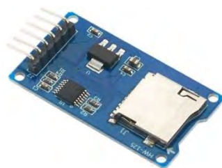
Módulo Lector de Memoria Micro SD CARD 74LVC125A
