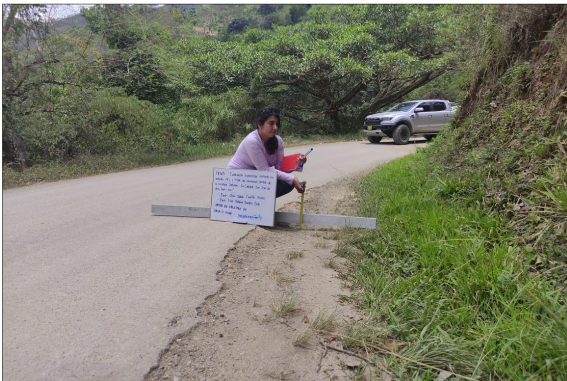
Identificación de daño conocido como desplazamiento en unidad de muestreo N° 24
