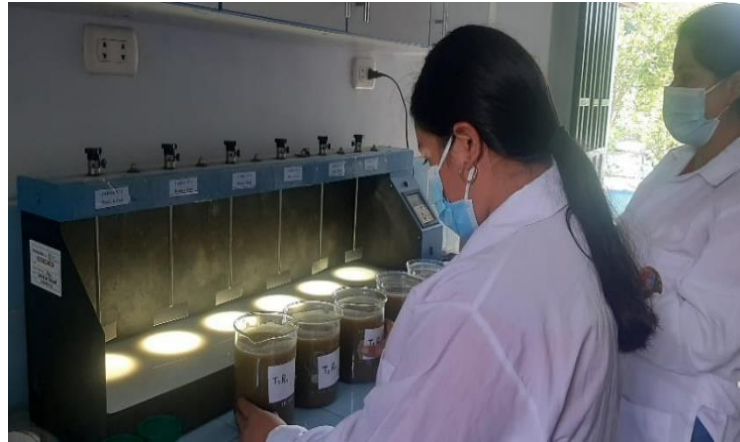
Figura 6. Proceso de coagulación y floculación llevado a cabo en el test de jaras.
