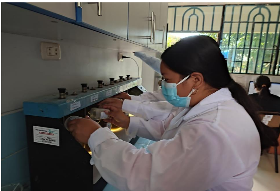
Anexo 27. Adición del coagulante (sulfato de aluminio).
