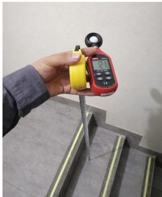
d) Medición espacio interior escalera, altura de 1m
