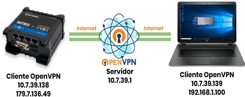
Figura 42. Esquema de comunicación de datos por VPN.
