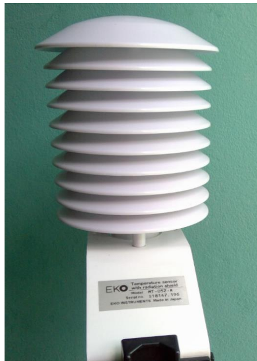
Figura 30. Instalación en base metálica del sensor de temperatura.
