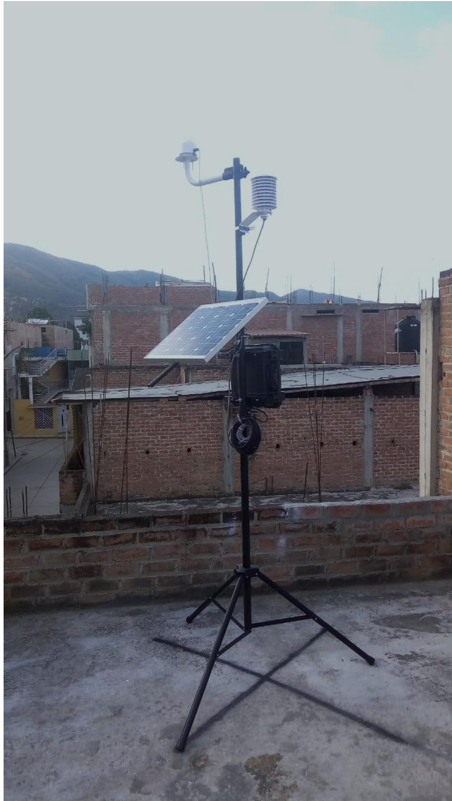
Figura 51. Estación de Medición solar Jaén para irradiancia solar y temperatura.
