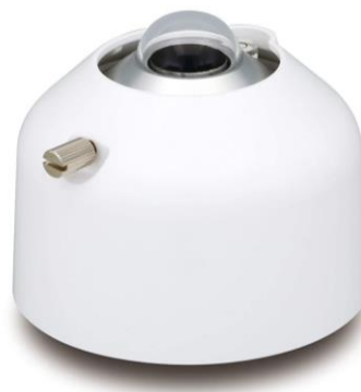
Figura 11. Piranómetro para medición de radiación global y difusa.
