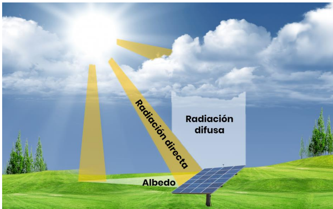
Figura 3. Propagación de la radiación solar en la superficie de la Tierra.
