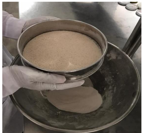
Figura 35. Tamizado de la pituca molida para la obtención de su harina mediante un tamizador
