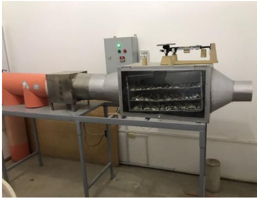
Figura 26. Secador de bandejas por aire forzado
