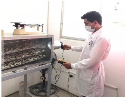
Figura 27. Control de temperatura y de la velocidad del aire forzado
