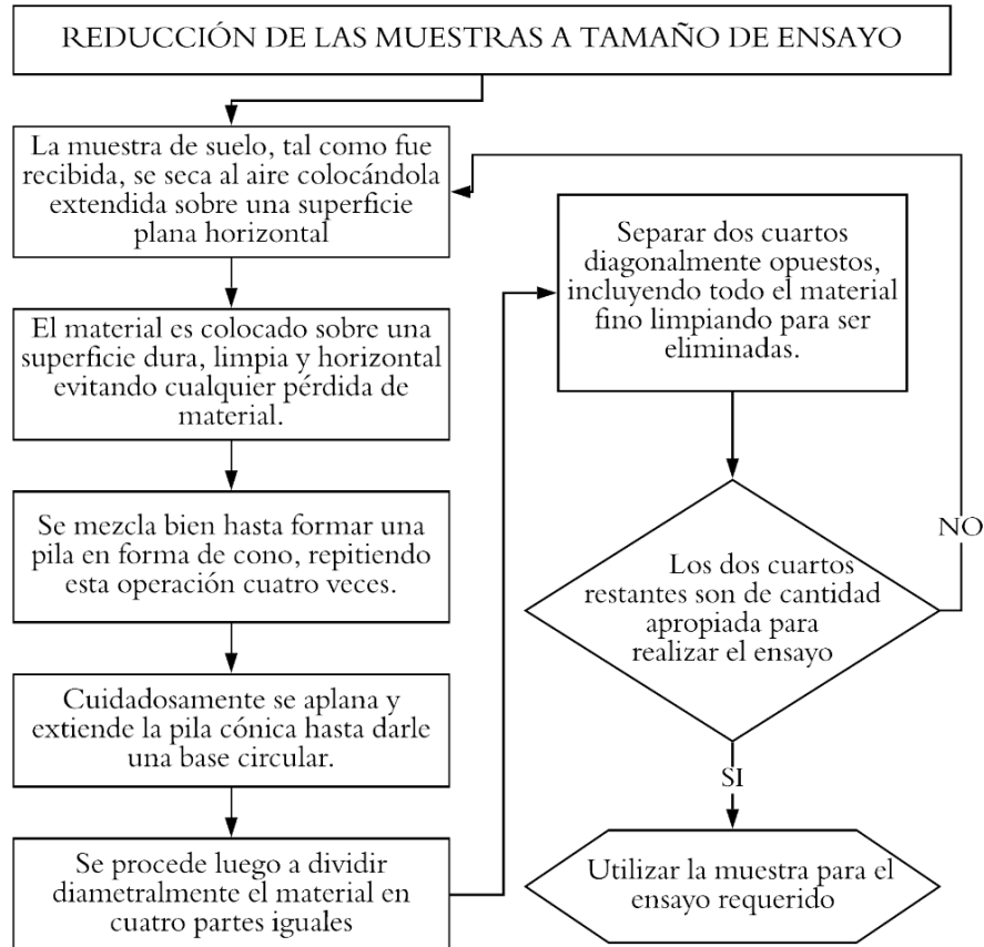
Figura 7. Diagrama de Flujo del procedimiento por el método del cuarteo para reducción de muestras a tamaño de ensayo.
