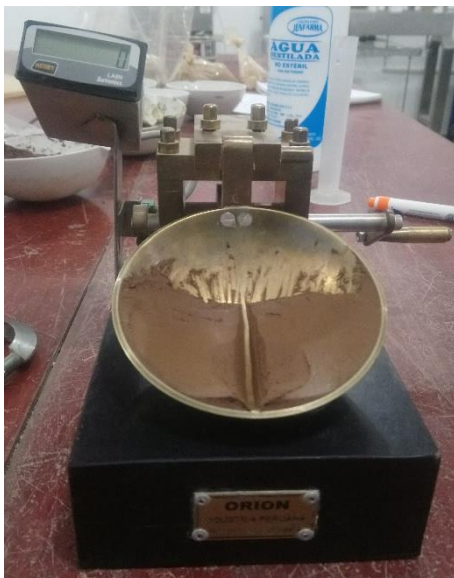
Figura 23. Colocación de la muestra en la copa de Casa Grande
