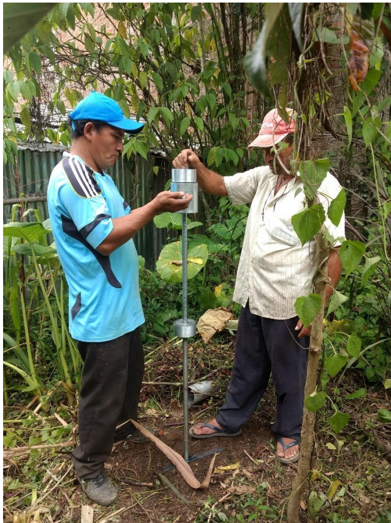
Fotografía 2: Vivienda N°08, Ensayo de Penetración Dinámica Ligera DPL-08.
