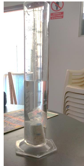
Figura 31. Introducción de la muestra con parafina en la probeta con agua destilada
