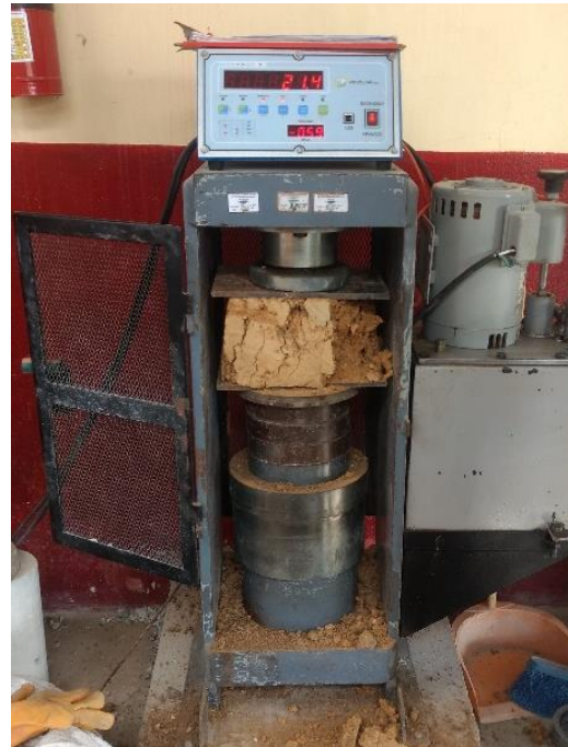
Figura 42. Carga máxima alcanzada antes de la ruptura del adobe
