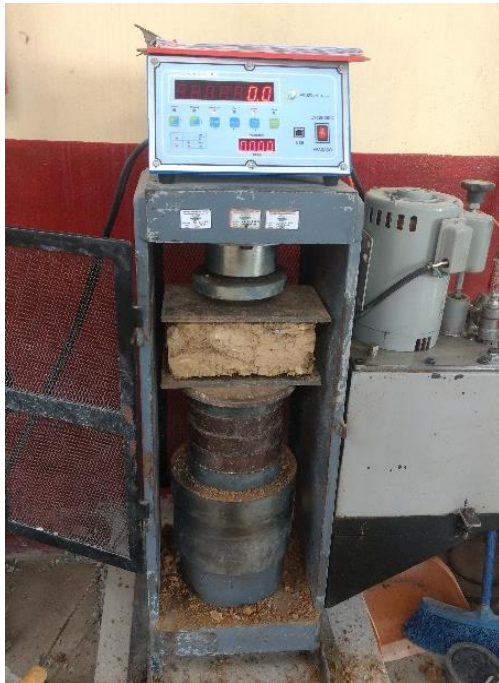
Figura 41. Adobe colocado en la Prensa Hidráulica antes de aplicar carga.
