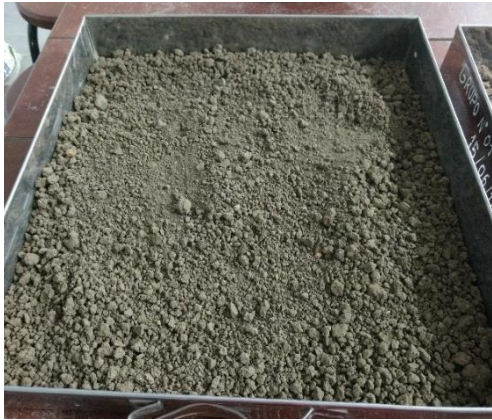
Figura 9. Colocación de la muestra sobre una superficie adecuada para ser mezclada.
