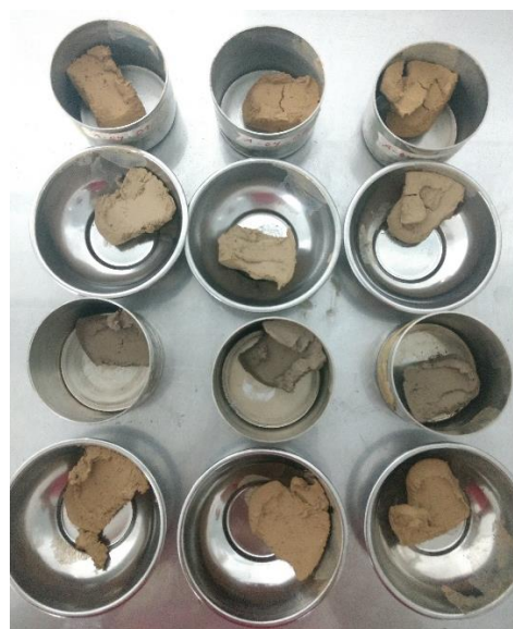
Figura 24. Muestras de suelo secadas en horno a 110°C +/- 5°C durante 24 horas
