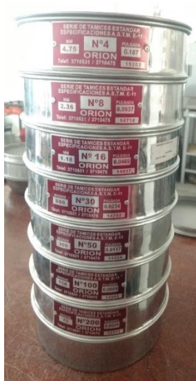
Figura 14. Selección y encaje de tamaños adecuados de los tamices.
