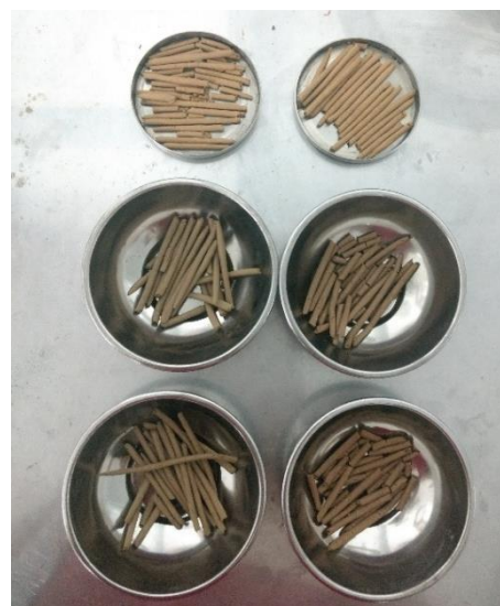
Figura 27. Muestras de suelo secadas en horno a 110°C +/- 5°C durante 24 horas
