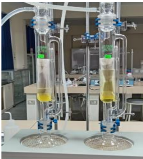
Figura 42 Determinación de porcentaje de materia grasa
