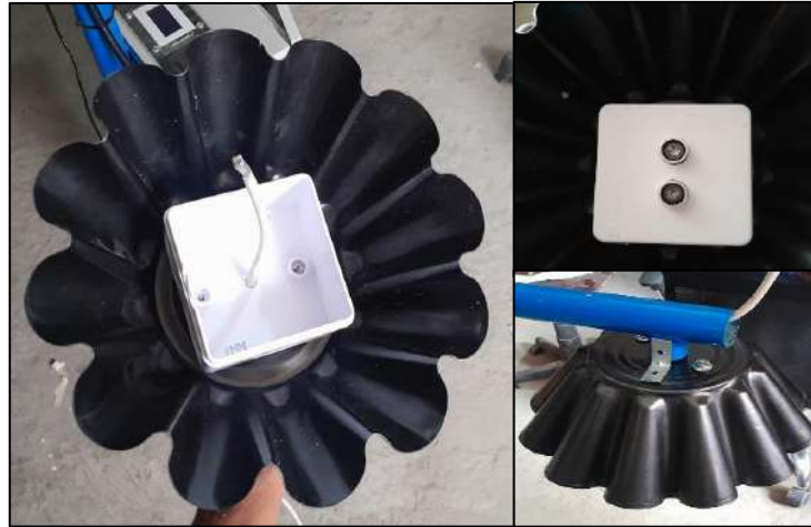
Figura 17. Carcasa adaptada para proteger a sensor Ultrasónico US- 100
