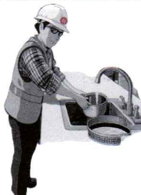
Lavado de la muestra en el tamiz N° 200
