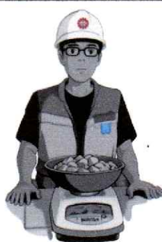
Pesado de recipiente + muestra húmeda
