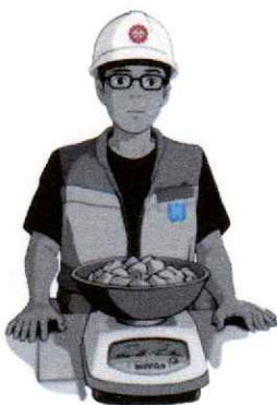
Pesado de la muestra seca sin lavar
