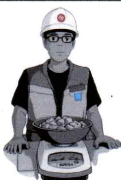
Pesado de recipiente + muestra húmeda
