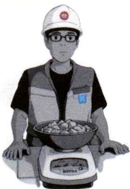
Pesado de la muestra seca sin lavar
