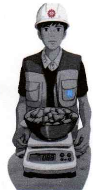
Pesado de muestra lavada y secada
